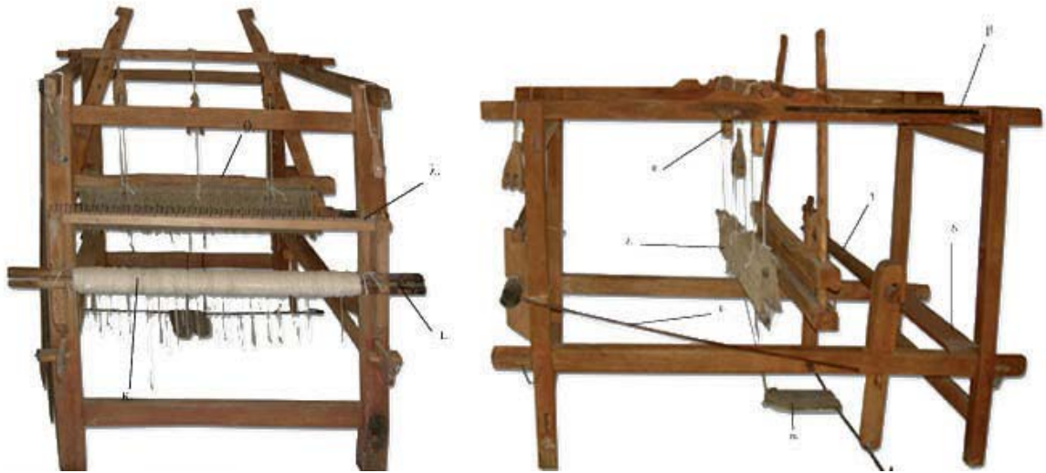
Εικόνα 1 – 10. Αργαλειός, Λουτράκι. α. Καρούλια, β. Προκίδα, γ. Αντί Πισάδι, δ. Κάθισμα, ε. Φρένο Στημονιού, ζ. Μυτάρια, η. Πέδιλα ή Πετάλια, θ. Χτένι, ι. Αντί Προστάδι, κ. Στημόνι, λ. Οδηγός. 22
