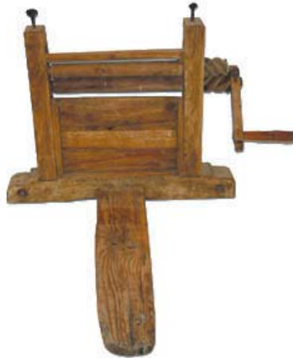
Εικόνα 1 – 12. Εκκοκκιστήριο βάμβακος με ξύλινο κοχλία, Καβάλα. 24
