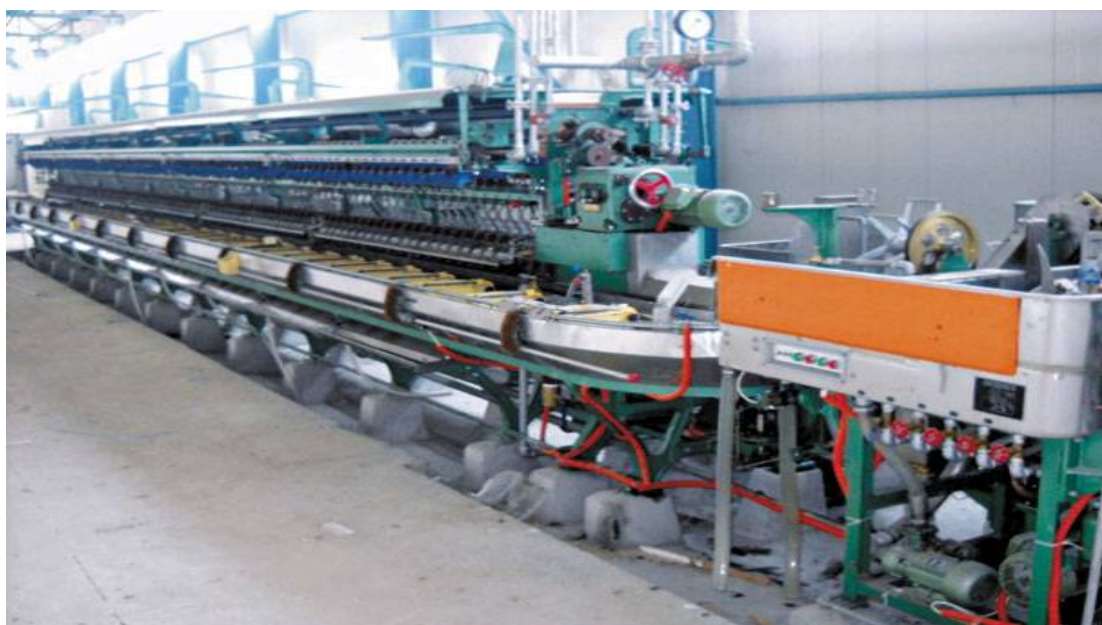
Εικόνα 3.12: Αναπήνιση κουκουλιών σε σύγχρονο αναπηνιστήριο.
