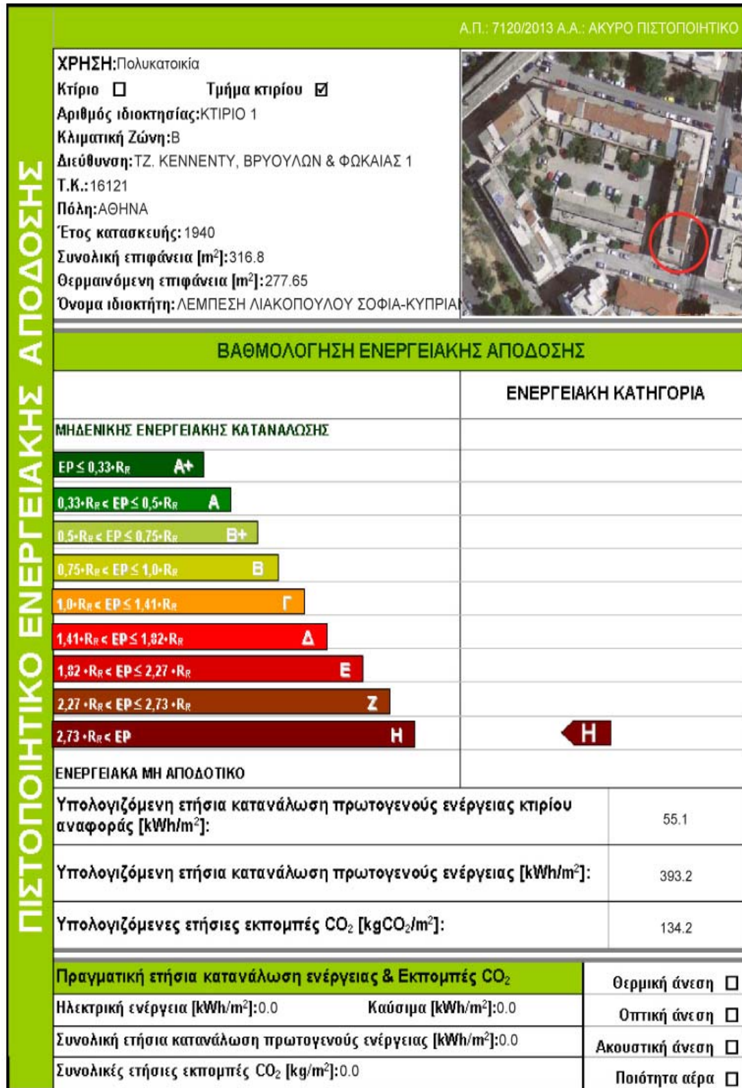
Σχήμα 6.1: Πιστοποιητικό Ενεργειακής απόδοσης για το Κτίριο 1
