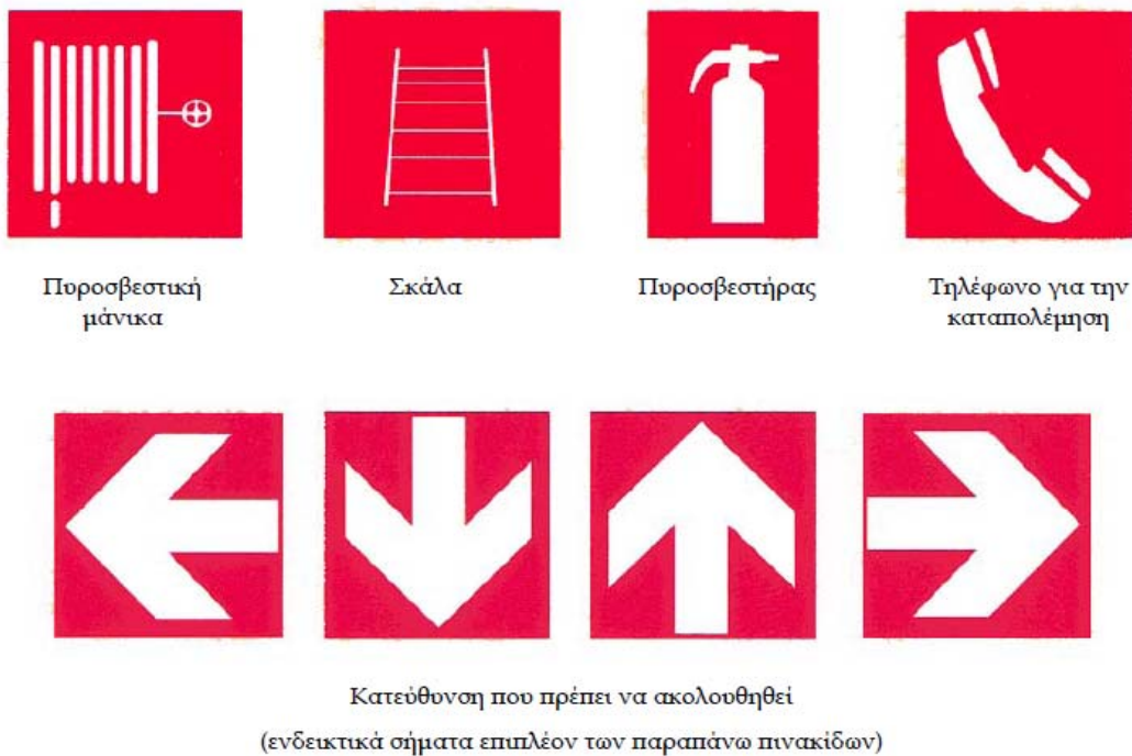
Εικόνα 15 Πινακίδες πυρασφάλειας και προσανατολισμού σε κατάσταση κινδύνου
