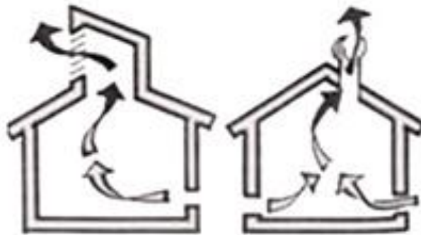
Εικόνα 28: Λειτουργία πύργου αερισμού (Πηγή: http://www.cres.gr/energy_saving/Ktiria/fysikos_drosismos_fysikos_aerismos.htm )
