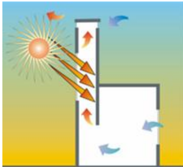
Εικόνα 29: Λειτουργία ηλιακής καμινάδας(Πηγή: http://www.cres.gr/energy_saving/Ktiria/fysikos_drosismos_fysikos_aerismos.htm )
