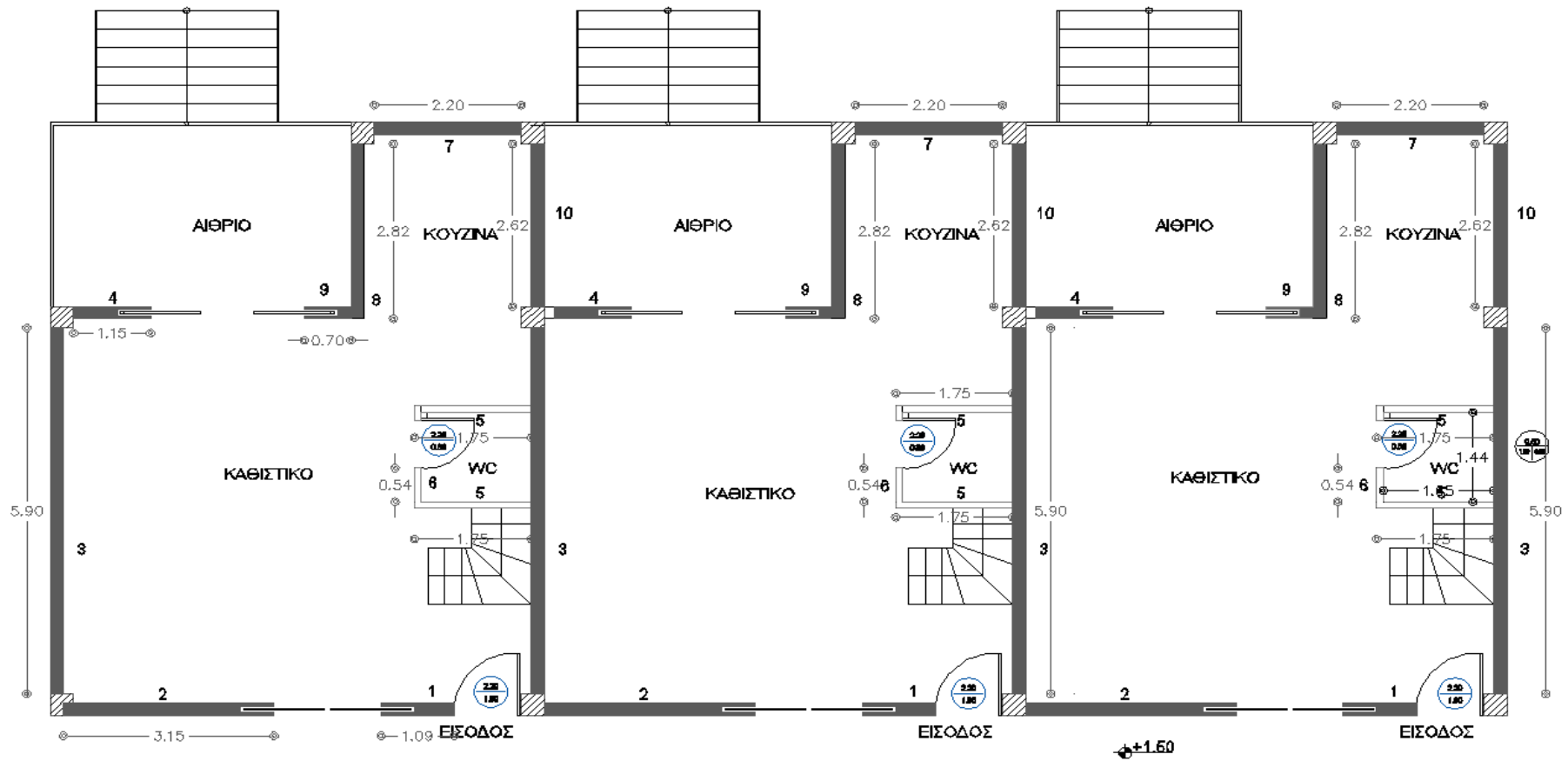
Σχήμα 41 Σχέδια προμέτρησης ματακικής τοιχοποιίας ισογείου
