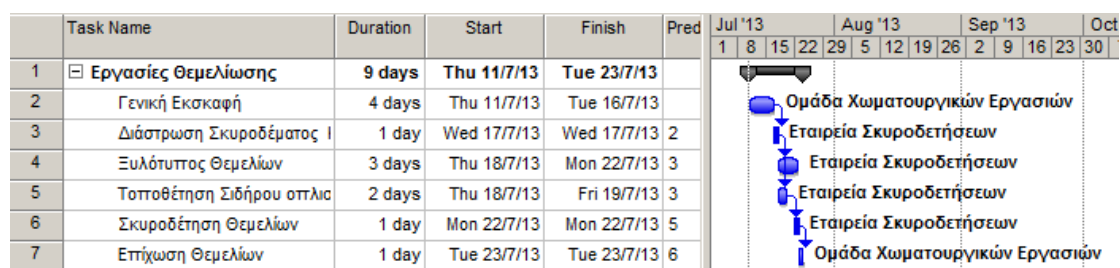
Σχήμα 54 Επιμέρους εργασίες χωματουργικών εργασιών
