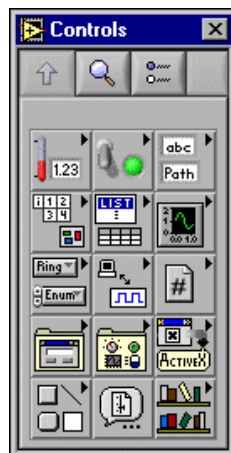
Εικόνα 2.2 Control Palette του Front panel
