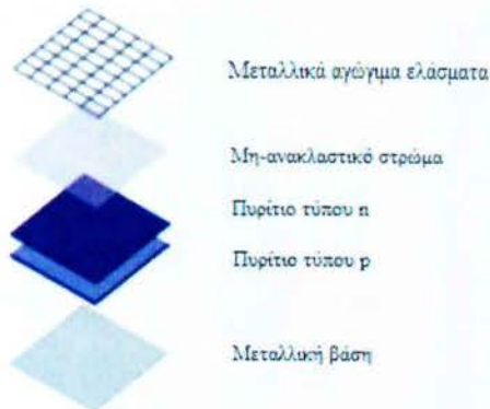
Εικόνα 1.22: Δομή ηλιακού κελιού
