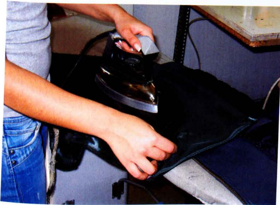
Εικ. 36: Σιδέρωμα δερμάτινου ενδύματος με τη χρήση φόδρας
