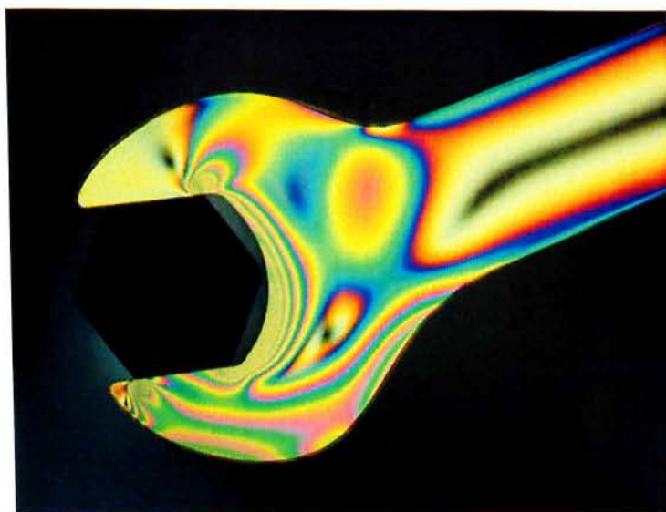
Σχήμα 7. Ανάλυση τάσεων με τη βοήθεια της μεθόδου της φωτοελαστικότητας
