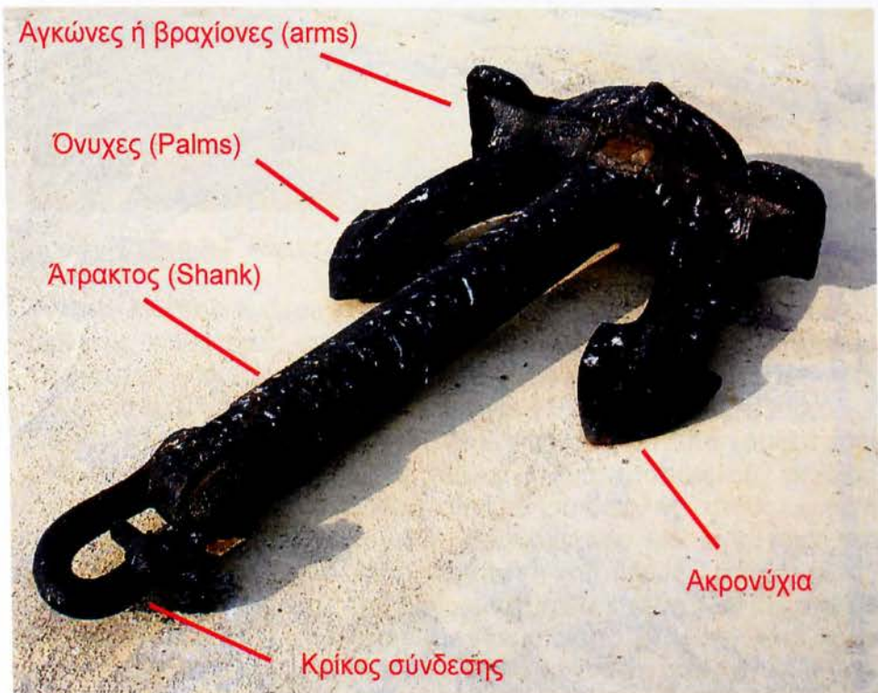
Σχήμα 3.1 Άγκυρα πλοίου τύπου "Hall". Τα κύρια μέρη μιας άγκυρας. [10]
