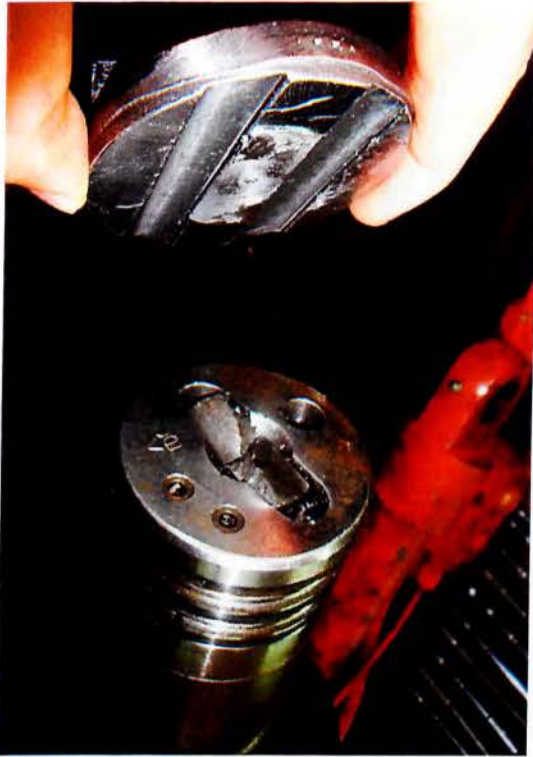
Σχήμα 6.3 Θραύσμα (δόντι) άγνωστου κόμπλερ εγκλωβισμένο στην υποδοχή του κύριου άξονα.
