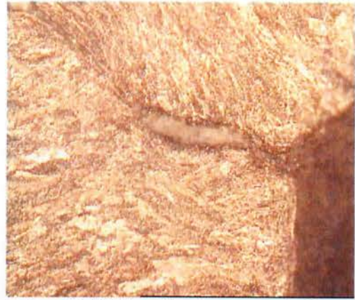
Σχήμα 12.11 Μικροδομή στο σημείο (3) του σχήματος 12.8 του δοκιμίου 2.1.1 (Mx500).
