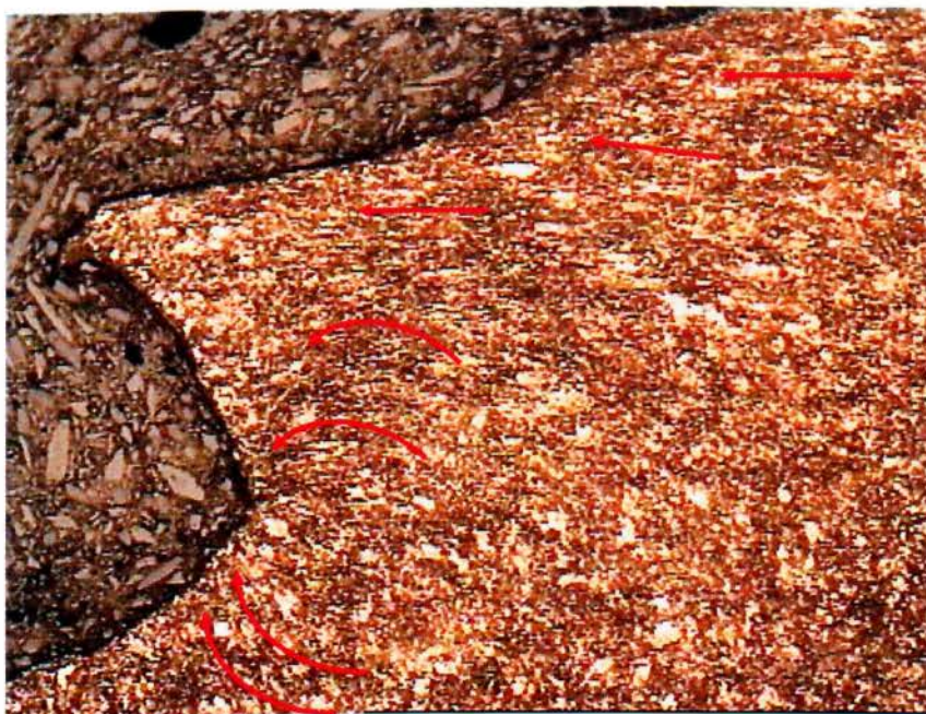
Σχήμα 12.4 Η μικροδομή του δοκιμίου 1.2 στην περιοχή καταπόνησης στο σημείο (3) του σχήματος 12.1 (Μ x 100).
