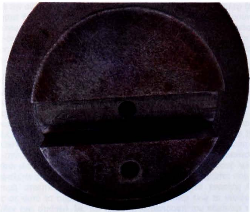
Σχήμα 6.7 Η πλευρά σύζευξης του valve spool με το κόμπλερ.
