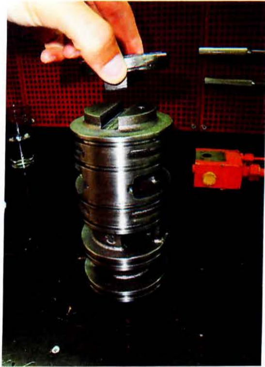
Σχήμα 6.4 Το κόμπλερ No 1 τοποθετείται στην άλλη υποδοχή του valve spool.
