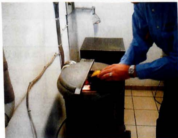
Σχήμα 9.2 Προετοιμασία της επιφάνειας με την αφαίρεση εξωτερικά εναποτεθειμένων σωματιδίων.
