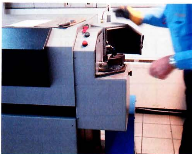
Σχήμα 9.3 Τοποθέτηση εξαρτήματος στο φασματογράφο για χημική ανάλυση.
