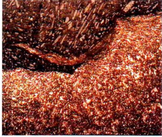
Σχήμα 12.14 Αρχή αποκόλλησης στο σημείο 6 του σχήματος 12.8 του δοκιμίου 2.1.1 (Mx100).
