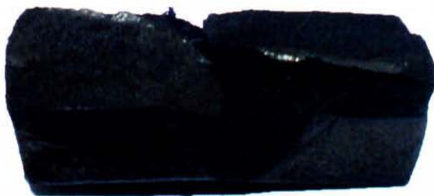
Σχήμα 8.4 Το θραύσμα του κόμπλερ No3 μετά την εξαγωγή του από τον κύριο άξονα.
