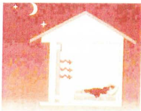
Εικόνα 4: Λειτουργία τοίχου Trombe Michel το χειμώνα
