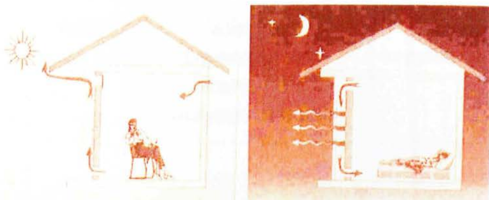
Εικόνα 5: Λειτουργία τοίχου Trombe Michel το καλοκαίρι
