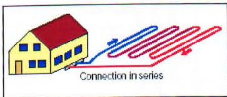
Οριζόντια εγκατάσταση των βρόγχων του εναλλάκτη θερμότητας σε συνδεσμολογία εν σειρά (αριστερά) και παράλληλη (δεξιά) . [7]
