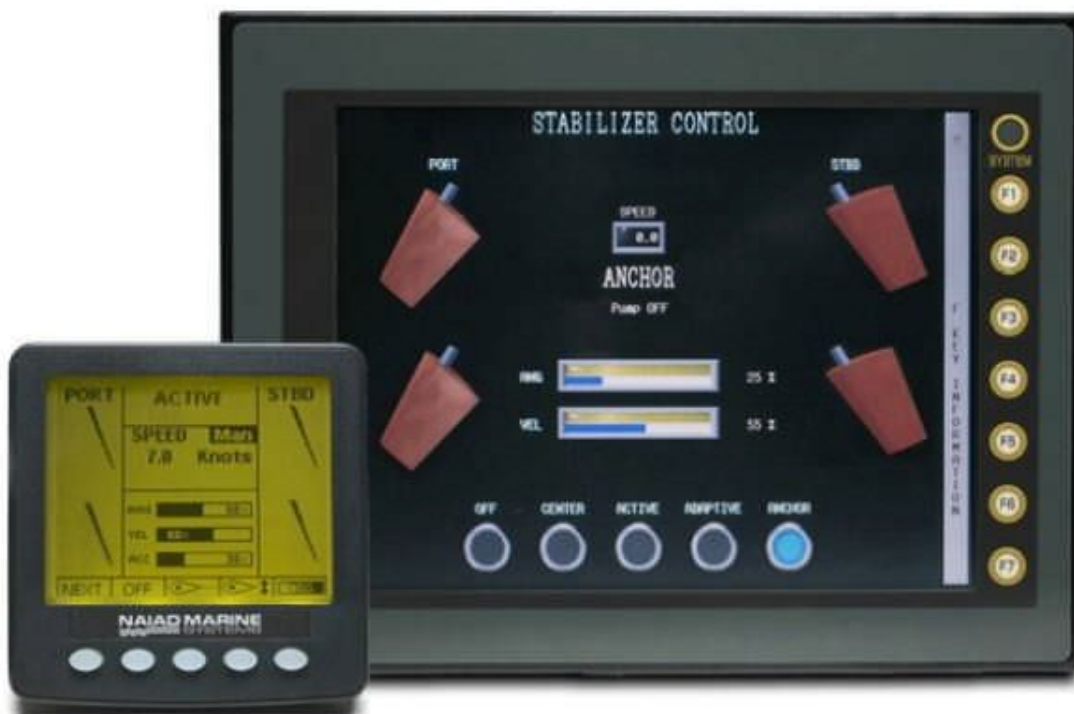
Σχήμα 8:Χειριστήριο και οθόνη απεικόνισης συστήματος σταθμιστήρων
