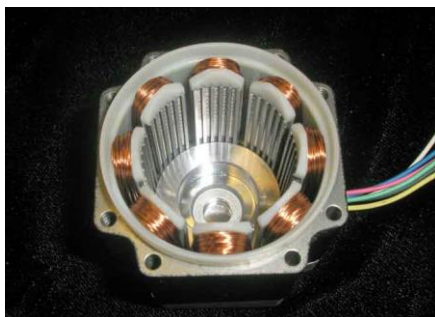
Σχήμα 4.9 Λεπτομέρειες κατασκευής βηματικού κινητήρα μεταβλητής μαγνητικής αντίδραση
