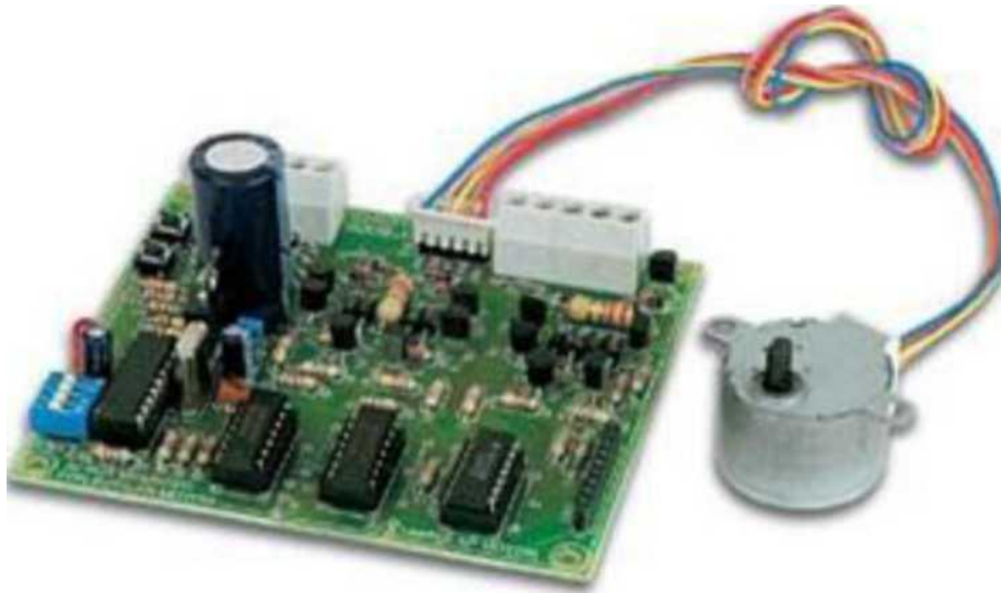
Σχήμα 3.19 Κάρτα οδήγησης βηματικού κινητήρα και κινητήρας. Η κάρτα μπορεί να χρησιμοποιηθεί για κινητήρες με μονοπολικά ή διπολικά τυλίγματα
