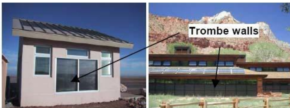
Σχήμα 3.27 Εφαρμογές τοίχου Trombe σε κτήρια χαμηλής ενέργειας
