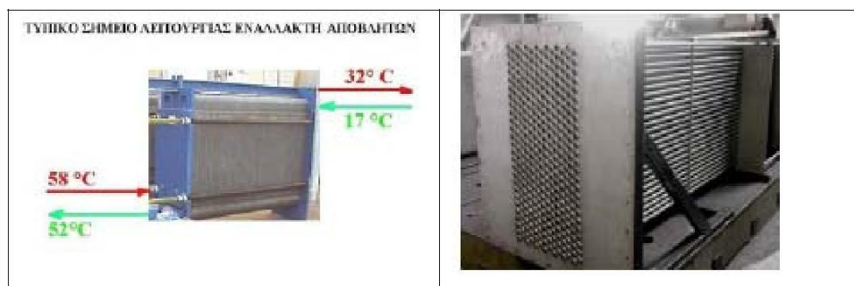
Σχήμα 7.13 Εναλλάκτες αποβλήτων. Αριστερά πλακοειδής και δεξιά σωληνωτό
