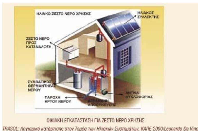
Σχήμα 7.1 Παραγωγή ζεστού νερού χρήσης με ηλιακά
