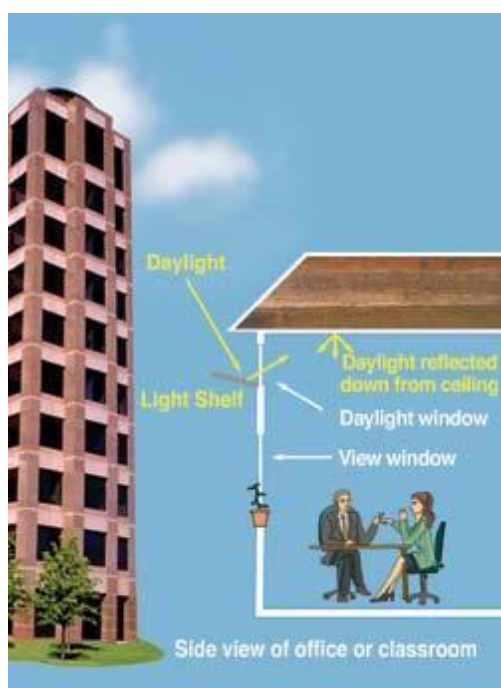
Σχήμα 6.13 Πόσο βαθιά σε ένα δωμάτιο μπορεί να φτάσει το φυσικό φως, ανάλογα με τις διαστάσεις του παραθύρου, συνδυασμένο με ράφι φωτισμού.
