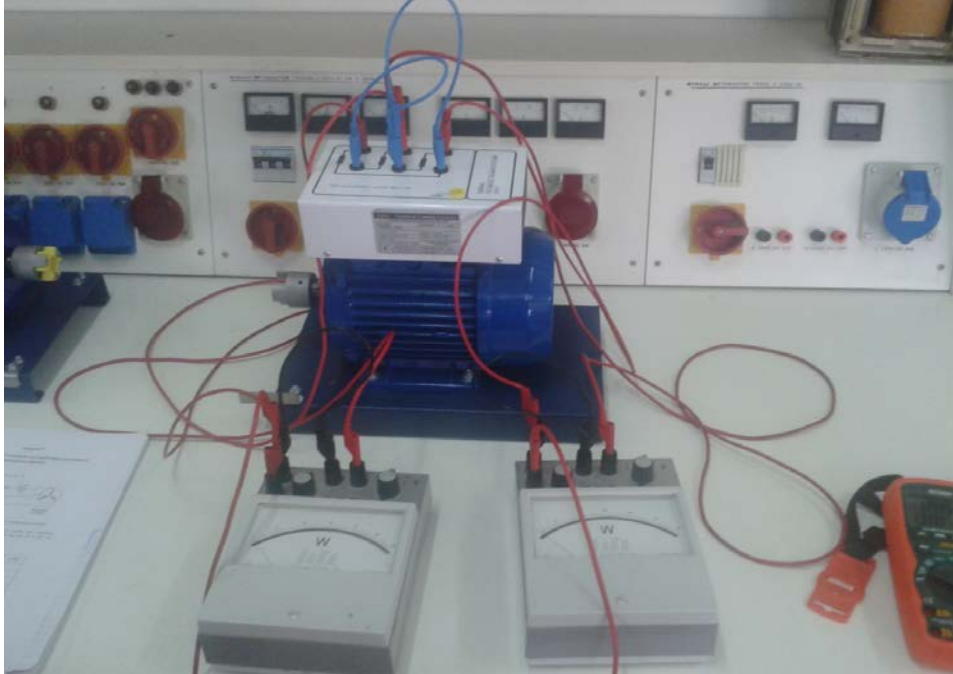
Σχήμα 2.4.3. Γεννήτρια εναλλασσόμενου ρεύματος συνδεδεμένη με 2 βαττόμετρα
