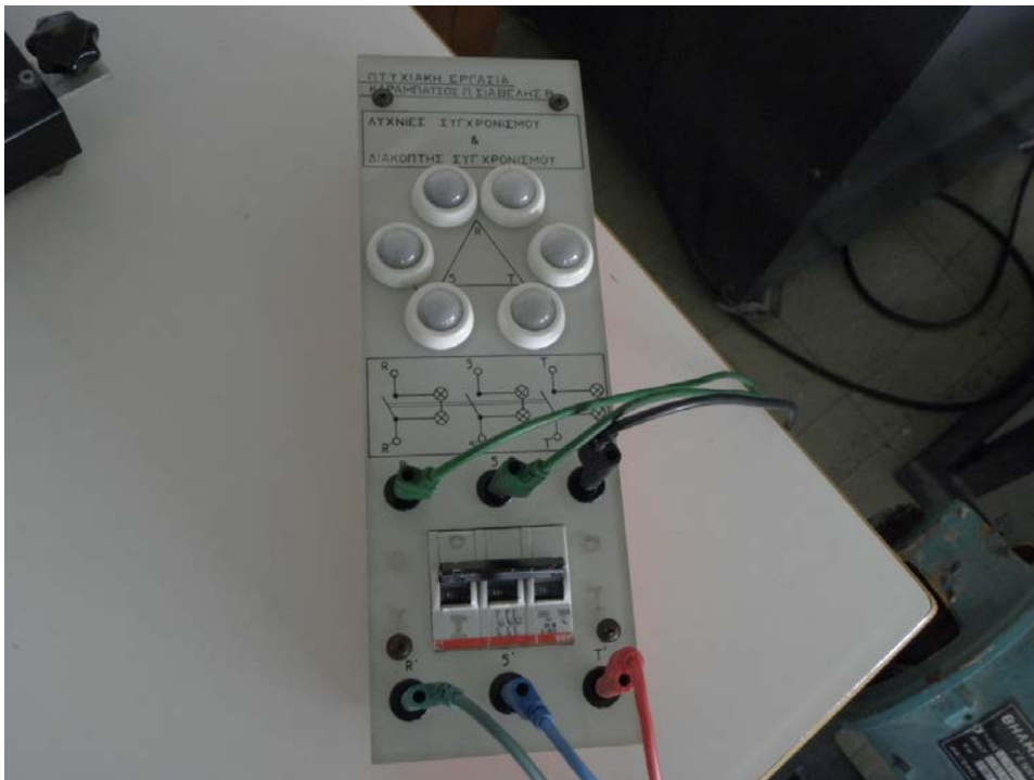
Σχήμα 2.4.6. Αυχνίες και διακόπτης συγχρονισμού για παραλληλισμό 2 γεννητριών
