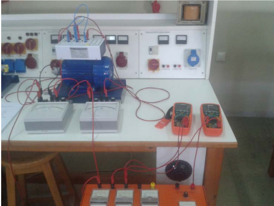
Σχήμα 2.4.4. Γεννήτρια εναλλασσόμενου ρεύματος συνδεδεμένη με 2 βαττόμετρα, αμπερόμετρο, βολτόμετρο με την διέγερση της τροφοδοτούμενη από πηγή συνεχούς τάσης
