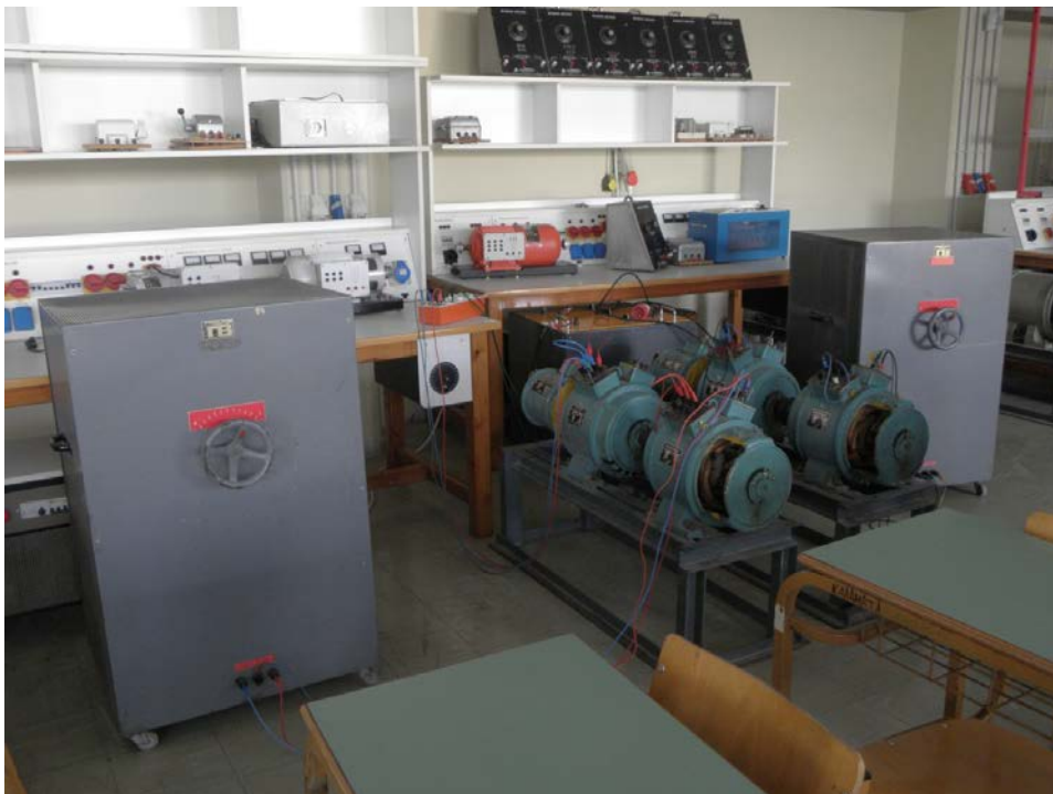
Σχήμα 2.1.3. Παραλληλισμός δύο γεννητριών μαζί με όλη τη διάταξη
