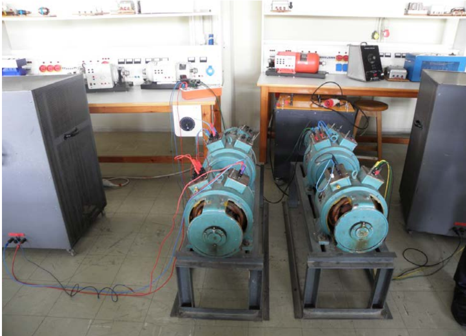
Σχήμα 2.4.5 Παραλληλισμός δύο γεννητριών μαζί με όλη την διάταξη
