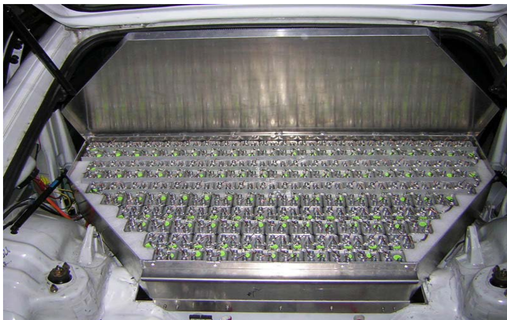
Σχήμα 3.20: Υπερπυκνωτές τοποθετημένοι σε όχημα
