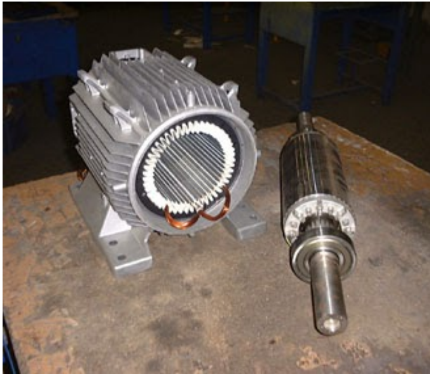
Σχήμα 4.14: Εικόνα Στάτης και δρομέας ασύγχρονης μηχανής
