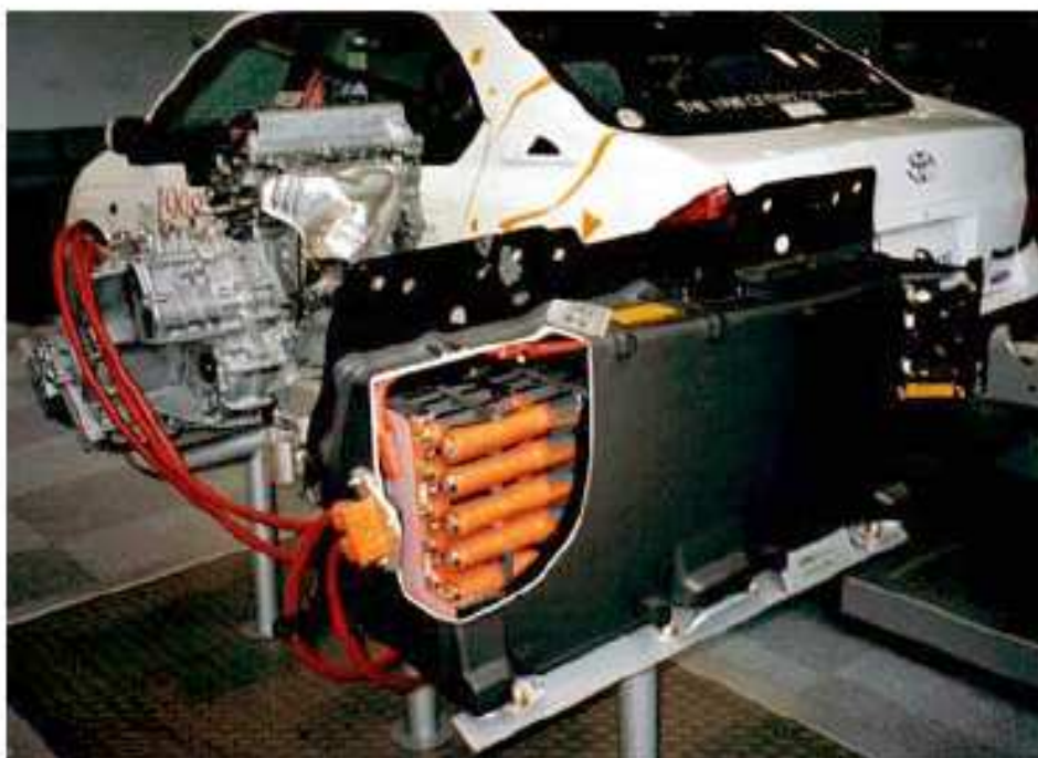
Σχήμα 3.12: Συστοιχία μπαταριών NiMH ενός ηλεκτρικού οχήματος.
