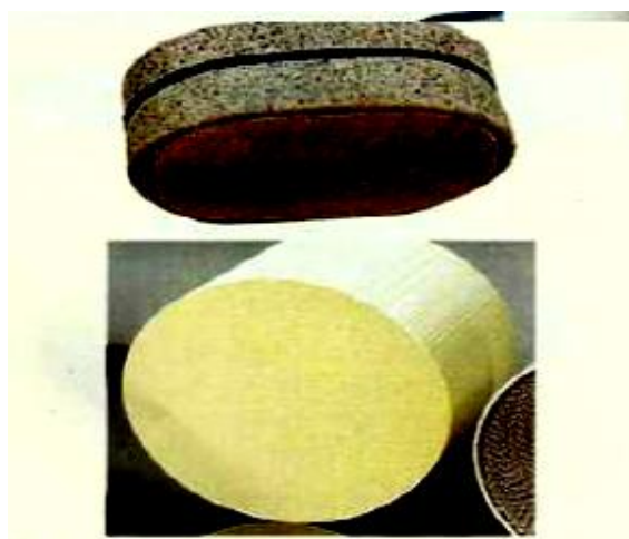
Εικόνα 2.4 Στρογγυλής και ωοειδούς μορφής κεραμικοί φορείς
