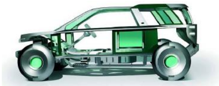
Εικόνα 5.40 Land Rover E-Terrain Technology Concept. Ο πίσω άξονας εφοδιάζεται με ηλεκτροκινητήρες που αυξάνουν την ασκούμενη ροπή όταν αυτό απαιτηθεί
