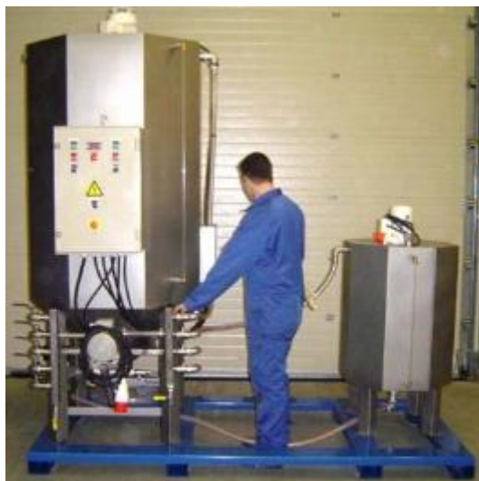
Εικόνα 5.14 Παρασκευή βιοντίζελ από ελαιοκράμβη
