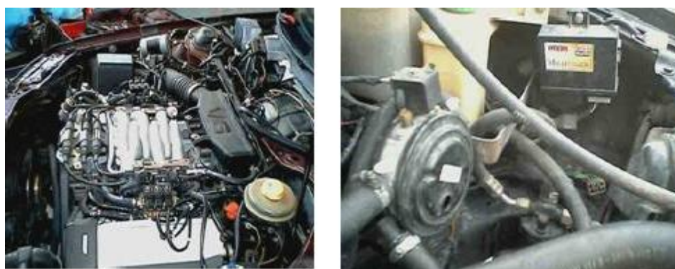
Εικόνα 5.5 Κινητήρας Audi 100 quattro v6 AUTOMATIC με μετατροπή για υγραέριο
