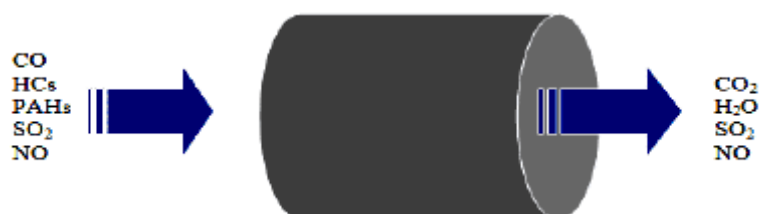
Εικόνα 3.10 Η λειτουργία του οξειδωτικού καταλύτη
