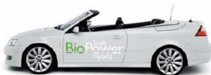
Εικόνα 5.39 Το Saab BioPower Hybrid με συνδυασμό χρήσης βιοαιθανόλης και ηλεκτρικής
