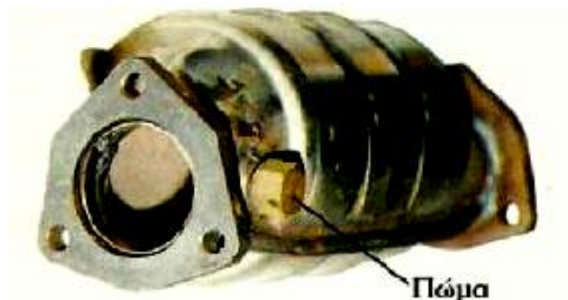
Εικόνα 2.13 Αφαιρούμενο πώμα για τη μέτρηση των ρύπων των καυσαερίων
