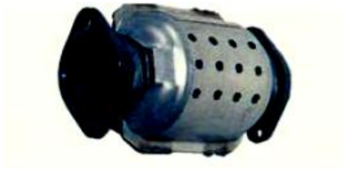
Εικόνα 2.11 Ασπίδα θερμότητας εξωτερικά του περιβλήματος του μετατροπέα
