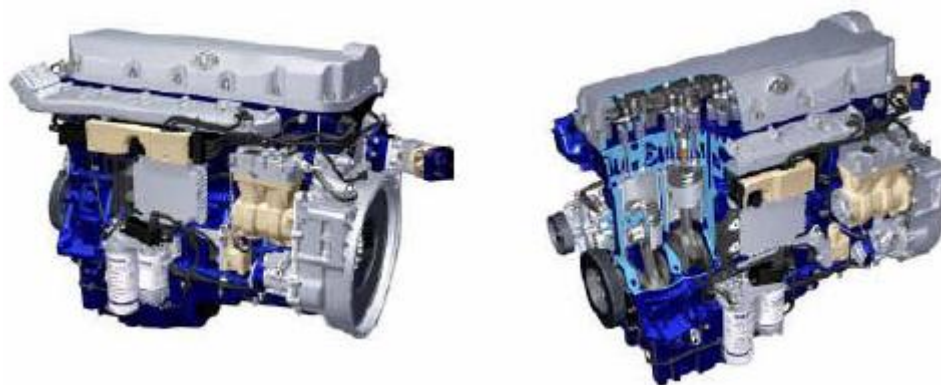
Εικόνα 5.26 Η μηχανή diesel της VOLVO D9A προσαρμοσμένη για τη χρήση του DME
