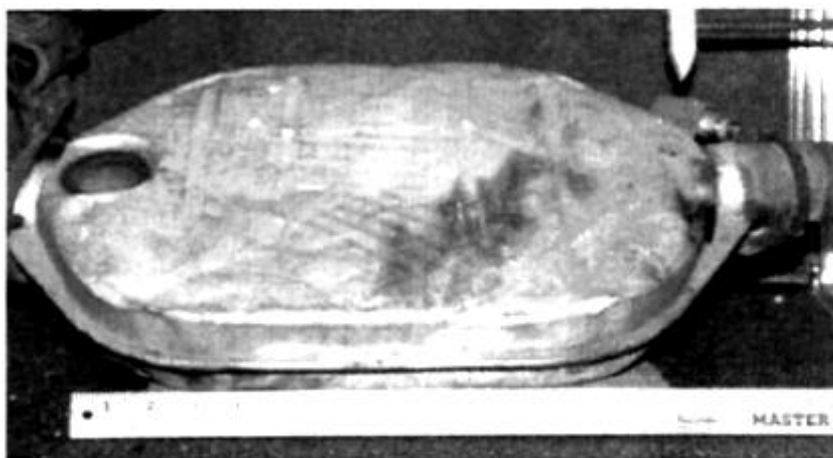
Εικόνα 2.3 Καταλυτικός μετατροπέας με αντικαθιστάμενα σφαιρίδια
