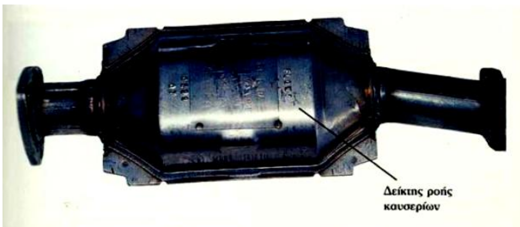
Εικόνα 2.7 Δείκτης της ορθής φοράς του μετατροπέα
