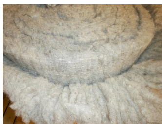
Εικόνα 2.4.2.3 Θερμομονωτικό στρώμα μαλλιού με περίβλημα πολυεστερικών ινών
