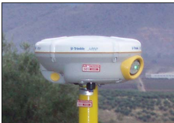
Φωτογραφία 2.3 Δέκτης GPS Trimble 5800.
