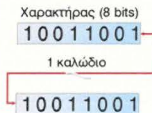
εικόνα 2-12: Σειριακή μετάδοση 8 bits
