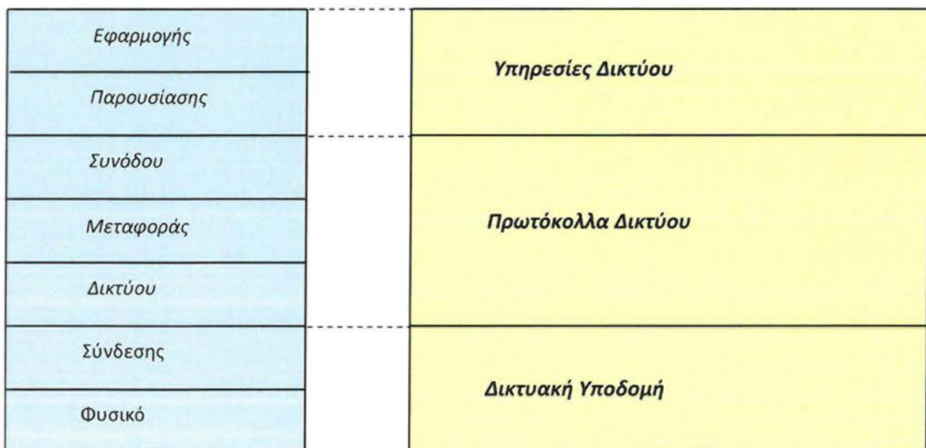
εικόνα 8-3: Συσχετισμός του μοντέλου 3 επιπέδων με το μοντέλο του OSI.
