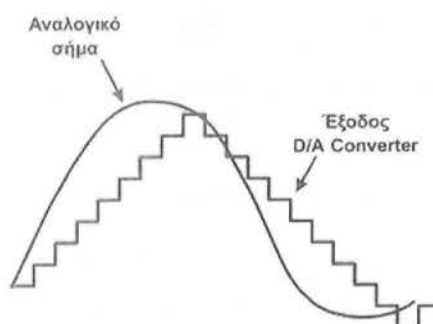
εικόνα 1-4: Σφάλμα προσέγγισης στη διαμόρφωση Δέλτα
