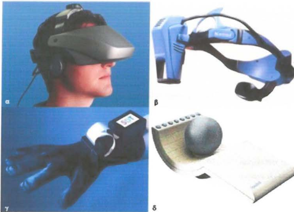
Εικόνα 4.1: Συσκευές εικονικής πραγματικότητας. α) Οθόνη προσαρμοσμένη στο κεφάλι, β) Γυαλιά ενισχυμένης πραγματικότητας, γ) γάντια δεδομένων, δ) σφαίρα πλοήγησης
