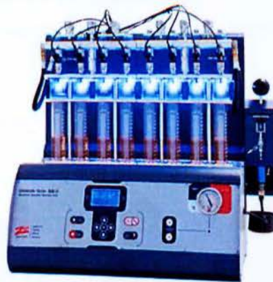
ΕΙΚΟΝΑ 4.19 Όργανο ελέγχου εγχυτήρων CARBON TECH GS Series
