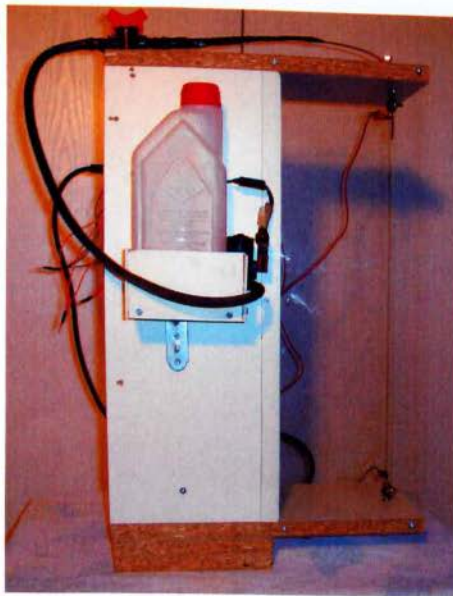
Εικόνα 13. Η δεξαμενή και η αντλία λαδιού με τους αγωγούς.
