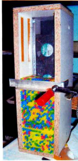
Εικόνα 9. Η τοποθέτηση Honeycom μέσα στο πλαίσιο μπροστά από τους ανεμιστήρες
