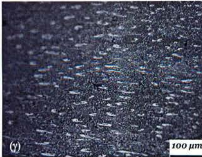
Σχ.3 Σύστημα Α: (α) Μακρογραφία, (β) Κατανομή μικροσκληρότητας, (γ) Μικροδομή εναπόθεσης, (δ) Μικροδομή πρώτης Θερμικά Επηρεασμένης Ζώνης.
