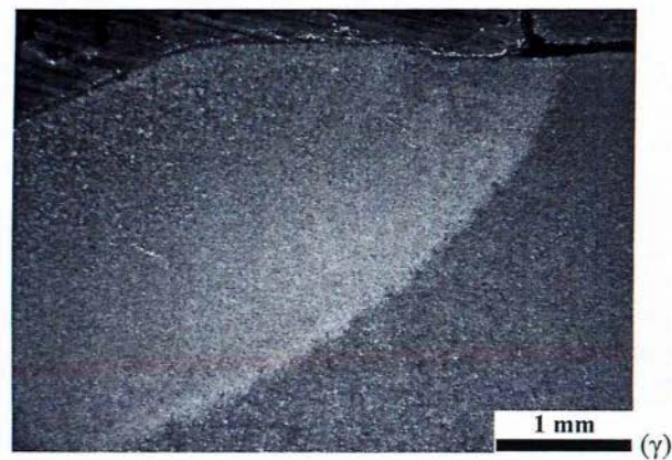
Σχήμα 3.23. (α) Μακρογραφία του συστήματος Γ, (β) Μακροδομή κεντρικής περιοχής της επιγόμωσης, (γ) Θερμικά επηρεασμένη ζώνη.
