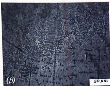
Σχ.2 (α) Μακρογραφία επιφανειακών ελαττωμάτων. (β) Οπτική μικρογραφία δενδριτικής ανάπτυξης.
