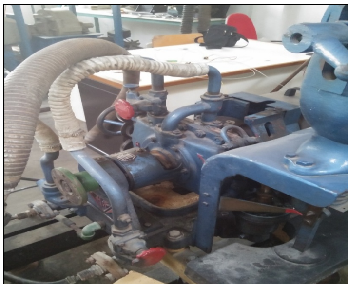
Υδραυλικού τύπου δυναμόμετρο στον εργαστηριακό χώρο
