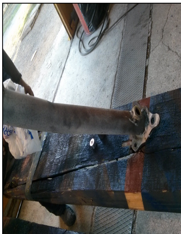
Η εξάτμιση όπως πλέον είναι με τις 2 “μούφες” Διακρίνονται και οι 2 προς τοποθέτηση “μούφες”
