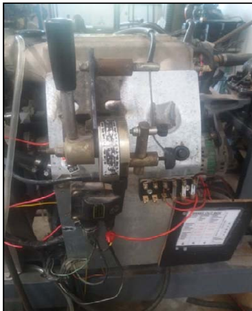
Διάταξη Πεταλούδας - Ποτενσιόμετρο
