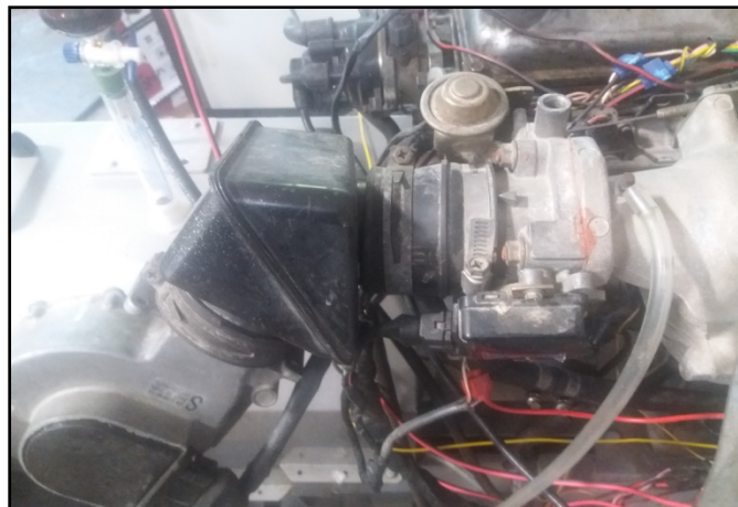
Εισαγωγή αέρα εργαστηριακής Μ.Ε.Κ. όπου παίρνουμε μετρήσεις για υποπίεση
