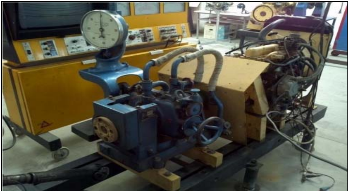
Υδραυλικού τύπου δυναμόμετρο στον εργαστηριακό χώρο
