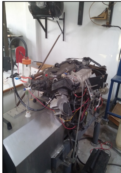
Πειραματική διάταξη απεικόνισης λειτουργίας ψεκαστήρα σε πραγματικό χρόνο λειτουργίας της Μ.Ε.Κ.
