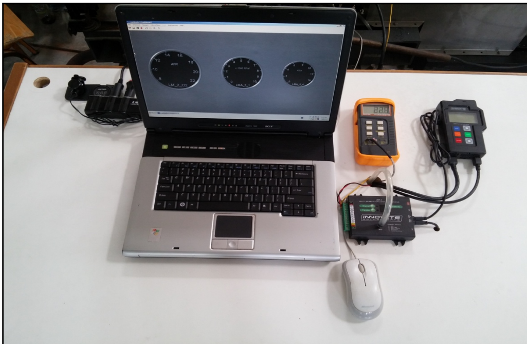
Σύνδεση όλων των μετρητικών οργάνων με έναν φορητό υπολογιστή
