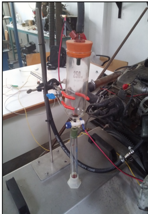
Πειραματική διάταξη απεικόνισης λειτουργίας ψεκαστήρα σε πραγματικό χρόνο λειτουργίας της Μ.Ε.Κ.
