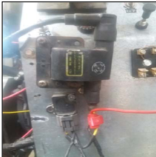
Πολλαπλασιαστής εργαστηριακής Μ.Ε.Κ. όπου παίρνουμε σήμα για μέτρηση των RPM
