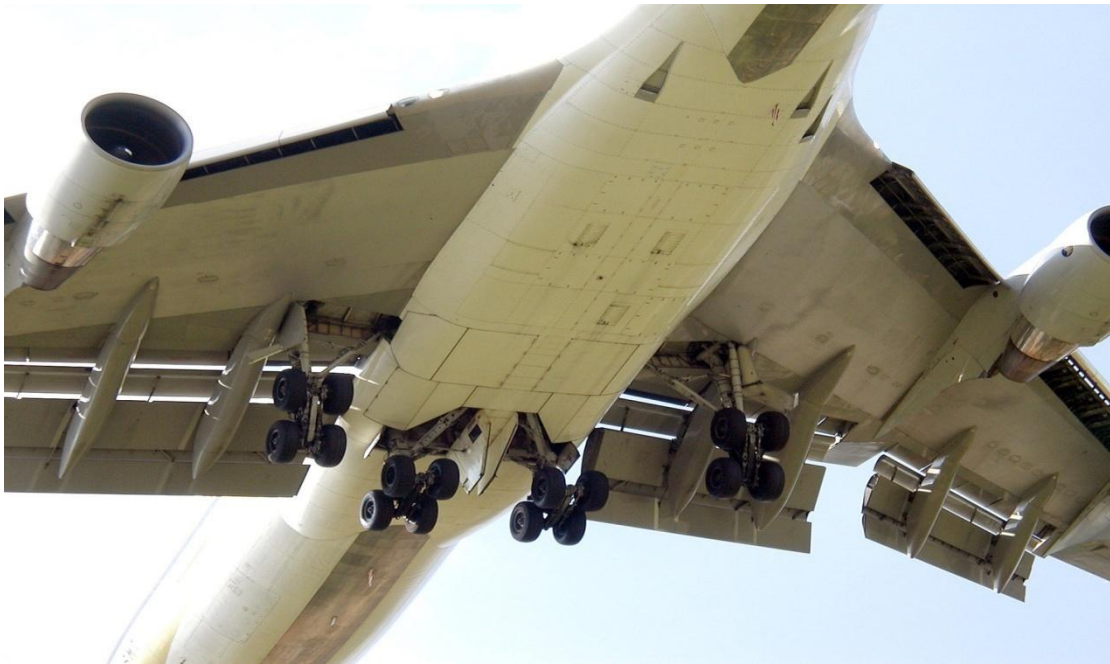
Εικ.5.31. Φτερά προσγείωσης (landing flaps) και άλλα εξαρτήματα αεροσκαφών κατασκευάζονται από 201.0 ή A356.0 κράματα
