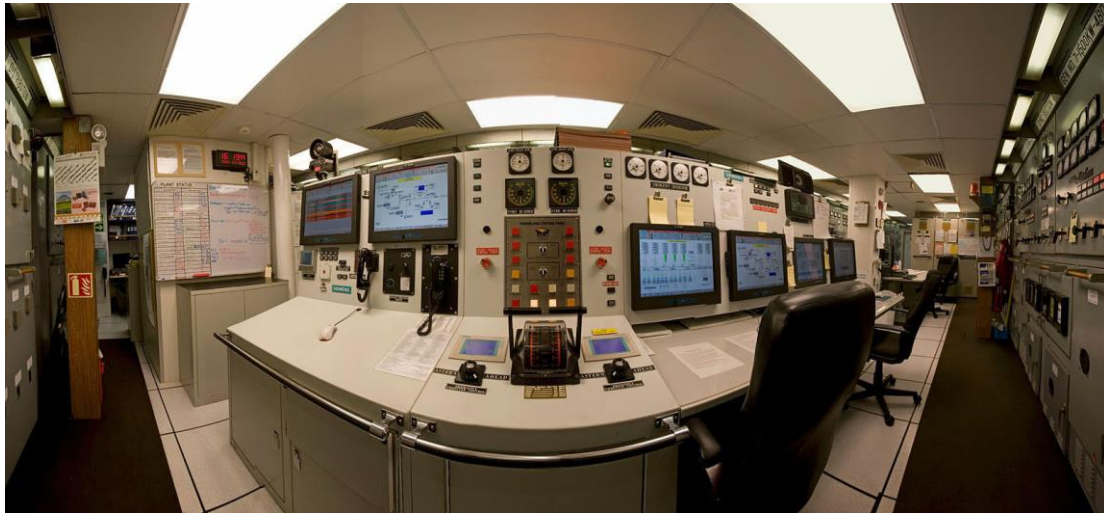
Εικόνα 4-2 Δωμάτιο ελέγχου (control room) που χειρίζεται τους αυτοματισμούς του πλοίου
