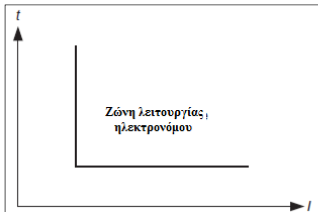
Σχήμα 16: Διαγραμματική απεικόνιση λειτουργίας H/N ορισμένου χρόνου
