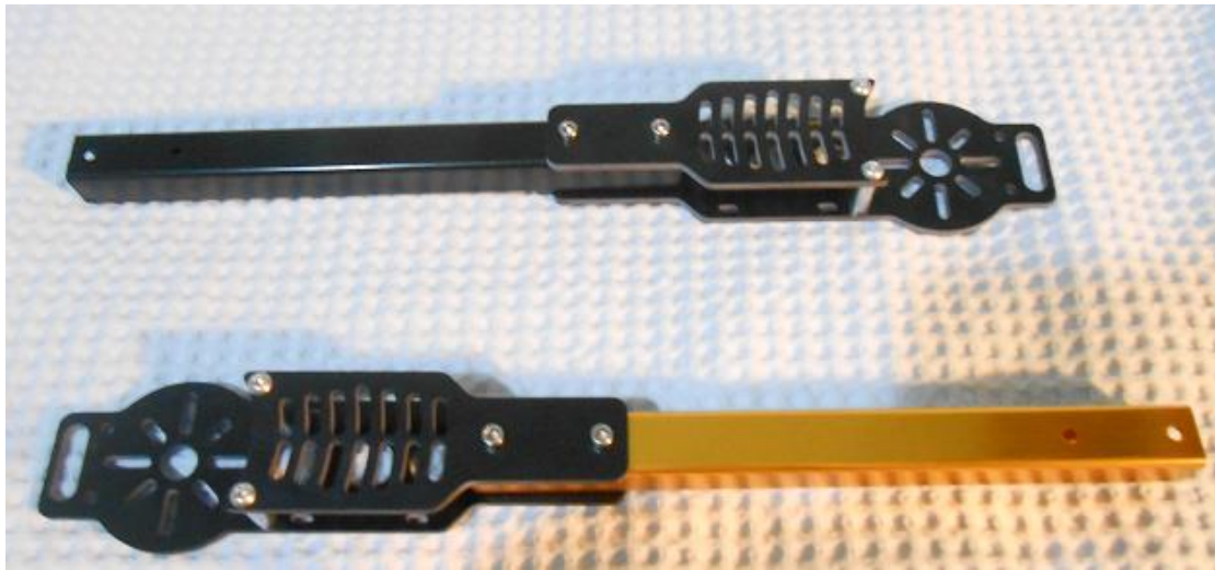
Εικόνα 37: Βραχίωνες διαφορετικού χρώματος του quadcopter για τον ευκολότερο προσανατολισμό του.
