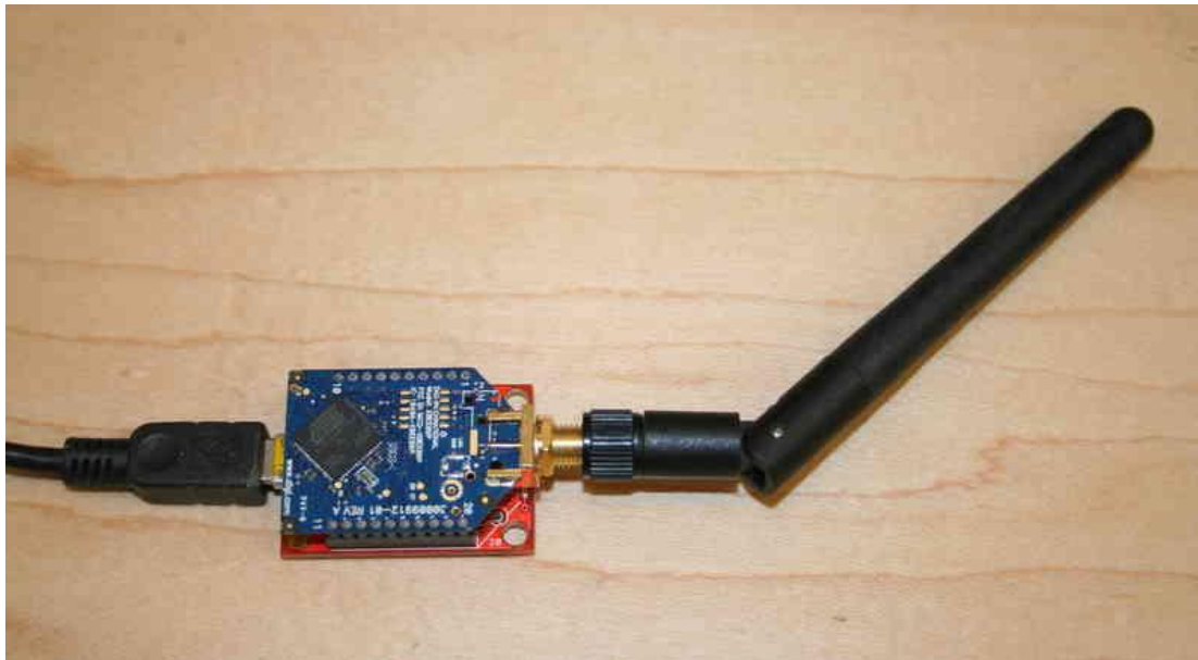
Εικόνα 53: Σύνδεση XBee με καλώδιο USB
