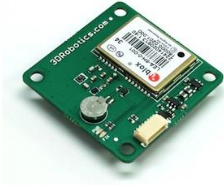
Εικόνα 21: Πλακέτα GPS που συνδέεται με το Ardupilot.
