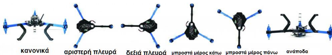
Εικόνα 48: Θέσεις που τοποθετούμε τον ελεγκτή πτήσης κατά την βαθμονόμηση του επιταχυνσιόμετρου
