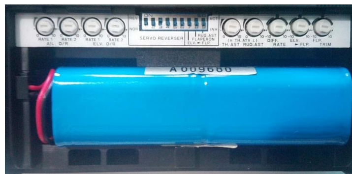
Εικόνα 45: Διακόπτες στο πίσω μέρος του χειριστήριου αντιστροφή των 6 καναλιών ενώ οι τρεις τελευταίοι για ειδικές λειτουργίες τις οποίες όμως δεν θα χρησιμοποιήσουμε στο quadcopter (είναι κυρίως για την πτήση
