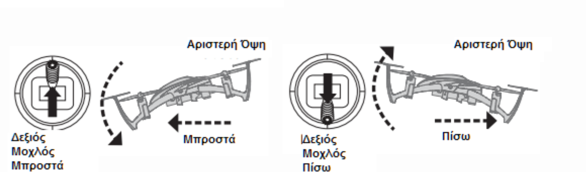
Εικόνα 62: Κίνηση Quadcopter ανάλογα με τον δεξίο μοχλό του χειριστήριου, μπροστά και πίσω
