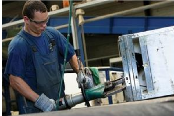
(Εικόνα 26. Αποσυναρμολόγηση ψυγείου σε μονάδα ανακύκλωσης της Ολλανδίας)
