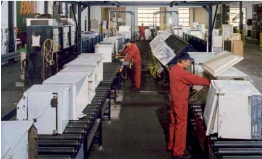
(Εικόνα 25. Αποσυναρμολόγηση ψυγείων στη μονάδα του Neukölln)
