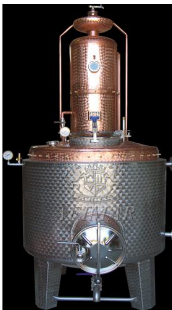
Εικόνα 3.3 Αποστακτήρας τσίπουρου AFIMAR 1300 lt [7]
