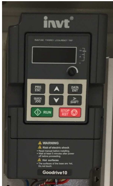
Εικόνα 3: INVERTER INVT Goodrive 80KW
