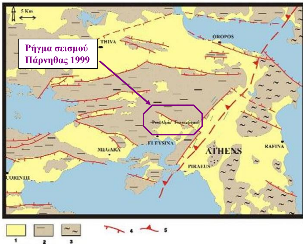
Σχήμα 3.1.1: Απλοποιημένος γεωλογικός - τεκτονικός χάρτης της Αττικής, 1. Μεταλπηκοί σχηματισμοί, 2. Μη μεταμορφωμένοι Αλπηκοί σχηματισμοί, 3. Μεταμορφωμένοι Αλπηκοί σχηματισμοί, 4. Κύρια ενεργά ρήγματα, 5. Γραμμή επώθησης (Παπανικολάου, Δ., κ.ά., 2002)
