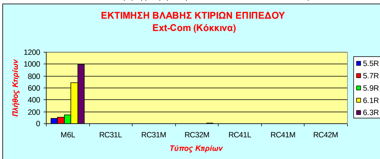
Εικόνα 4.8. Εκτίμηση βλάβης κτιρίων - επιπέδου Ext- Com – κόκκινα
