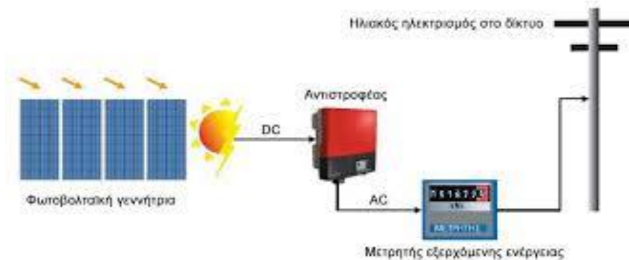
Εικόνα 23 "Θέση αντιστροφέα στο σύστημα" ( www.solarservice.gr/net-metering , n.d.)
