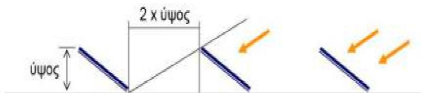
Εικόνα 11 "Κανόνας χωροθέτηση πάνελ" (Σύνδεσμος Εταιρειών Φωτοβολταϊκών. Ένας Πρακτικός Τεχνικός Οδηγός. Νοέμβριος 2010. )
