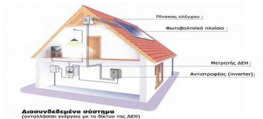
Εικόνα 27 "Διασυνδεδεμένο φωτοβολταϊκό σύστημα" (Οικονομοτεχνική Μελέτη Εγκατάστασης Διασυνδεδεμένου Οικιακού Συστήματος Φωτοβολταϊκών. Θεόδωρος Λαδάς )
