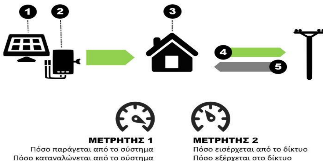
Εικόνα 31 "Λειτουργία συστήματος με net metering" ( netmetering.net.gr/ , n.d.)
