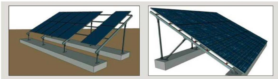
Εικόνα 17 "Σκυροδέτηση σταθερής βάσης σε δοκάρια από μπετόν" (Σύνδεσμος Εταιρειών Φωτοβολταϊκών. Ένας Πρακτικός Τεχνικός Οδηγός. Νοέμβριος 2010. )
