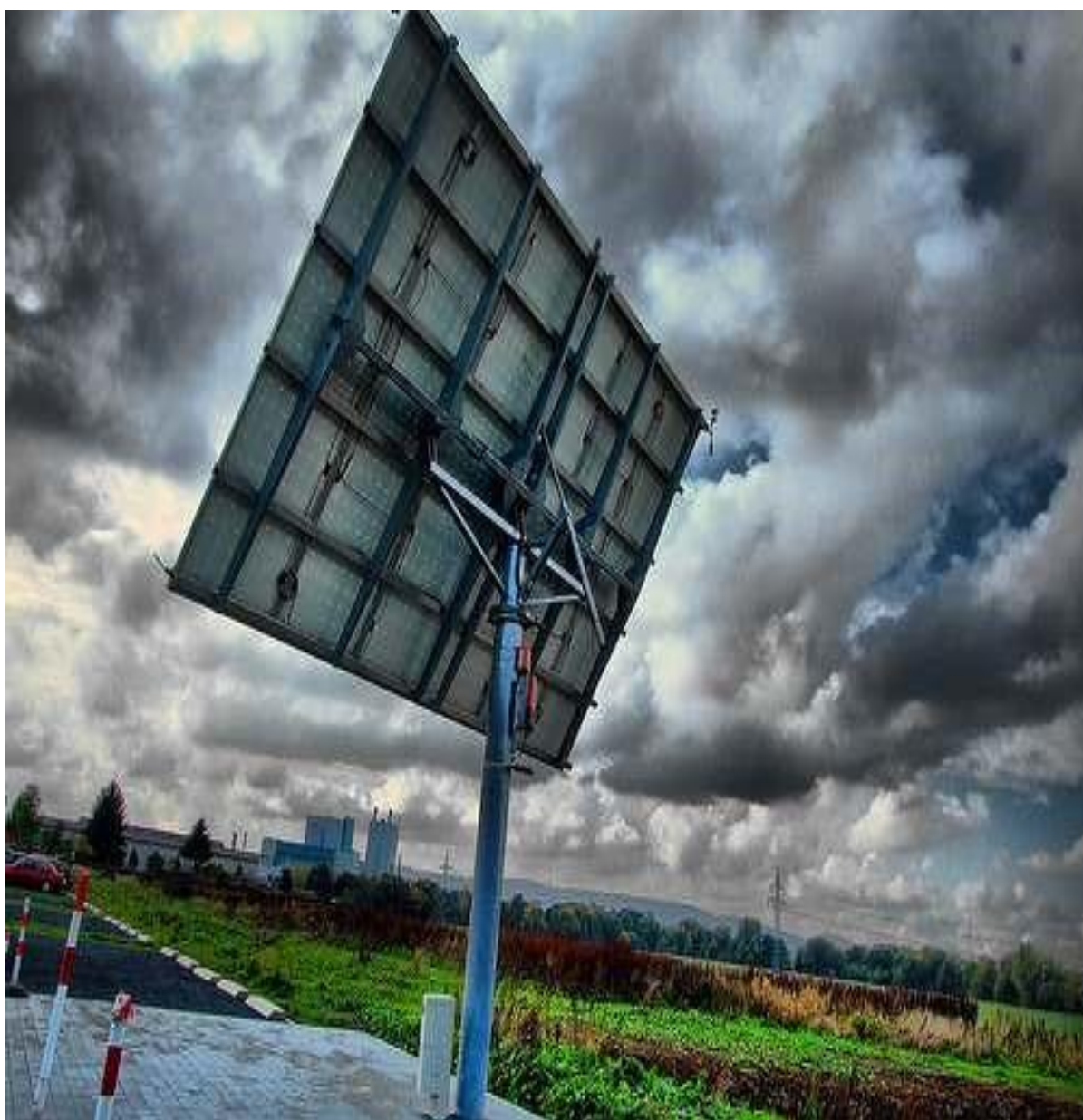
Εικόνα 21 "Σύστημα ιχνηλατήσεις του ήλιου διπλού άξονα" ( google.gr/systimaixnilitatis/diplosaxonas )
