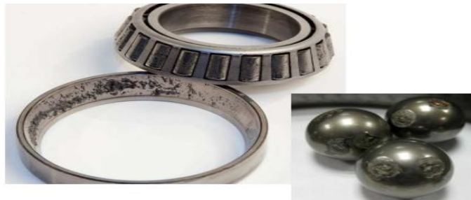
Εικόνα 3.4 Φθαρμένοι τριβείς κύλισης στις επιφάνειες επαφής [10]
