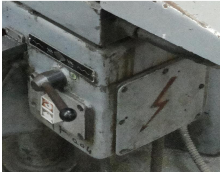
Εικόνα 4.20 Επιλογέας κίνησης τραπεζιού της φρεζομηχανής.
