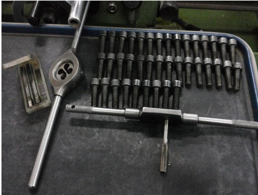
Εικόνα 4.9 Σπειροτόμοι M10x1.0 για εξωτερικό και εσωτερικό σπείρωμα.
