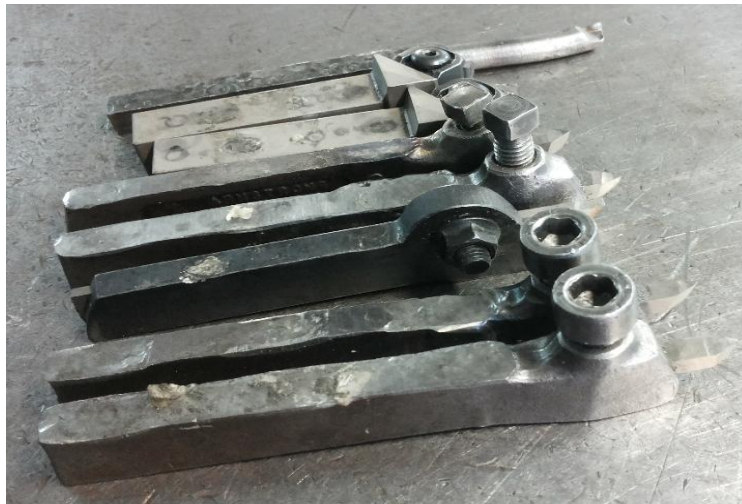
Εικόνα 4.5 Ορισμένες μανέλες τόνων πριν από την επιπέδωση.
