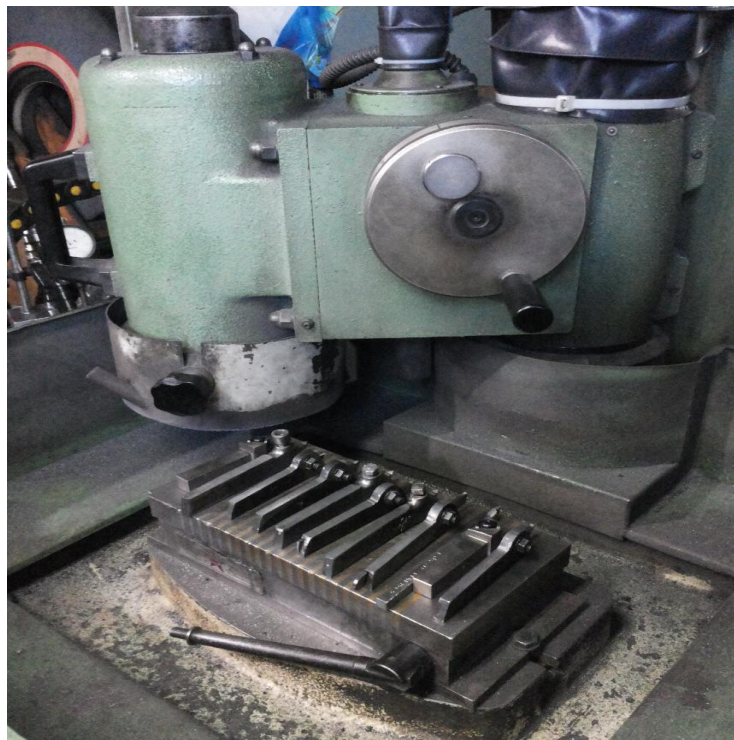
Εικόνα 4.7 Λειαντική μηχανή πρισματικών επιφανειών για την επιπέδωση των μανελών.
