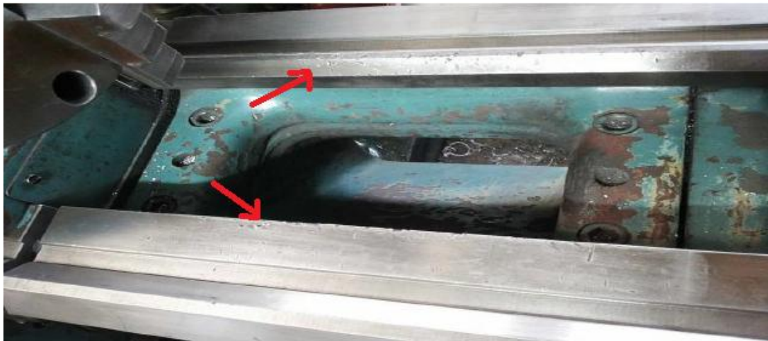
Εικόνα 3.3 Φθορά πρισματοδηγών σε τórνο.
