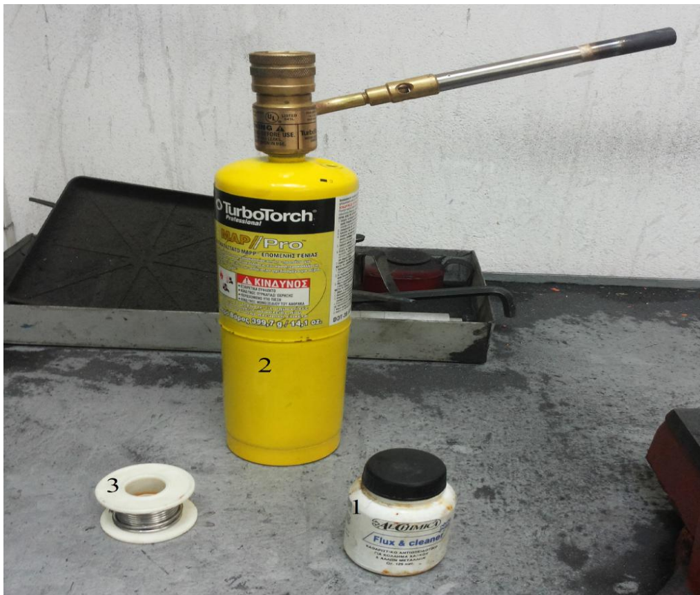
Εικόνα 4.26 Εργαλεία για την αποκατάσταση της διαρροής του πεπιεσμένου αέρα. 1) καθαριστικό. 2) φλόγιστρο. 3) σύρμα κόλλησης χαλκοσωλήνων.
