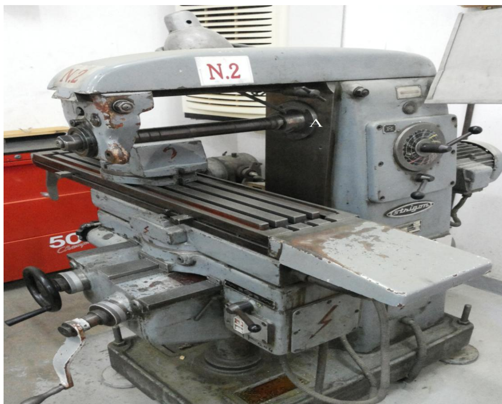
Εικόνα 4.28 Φρεζομηχανή οριζόντιου άξονα εργαστηρίου.
