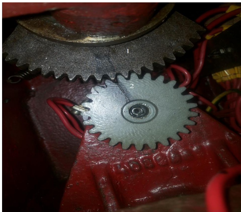
Εικόνα 4.21 Γρανάζια για την μετάδοση κίνησης του τραπεζιού της φρεζομηχανής.
