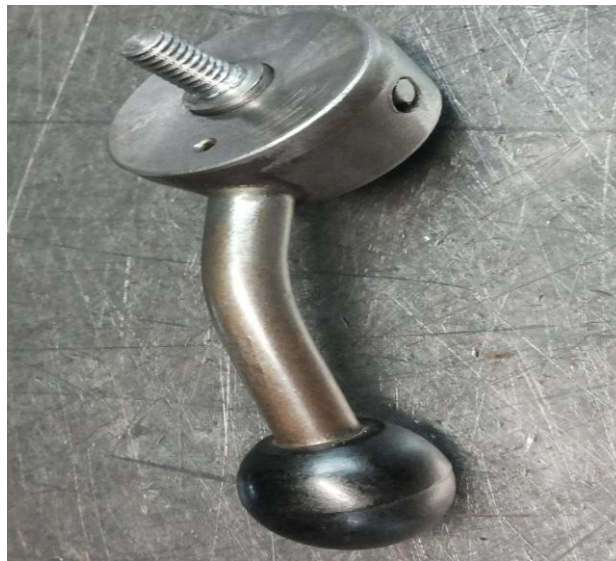
Εικόνα 4.17 Απεικόνιση συναρμολογημένης προέκτασης άξονα με το μοχλό και τον πείρο.
