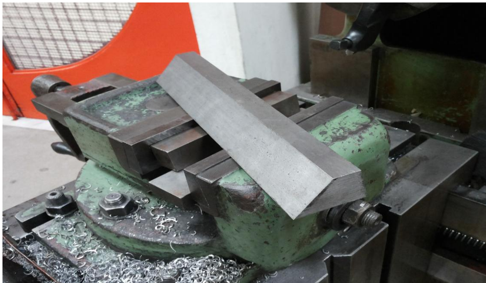
Εικόνα 4.33 Απεικόνιση πραγματικού πρισματοδηγού.
