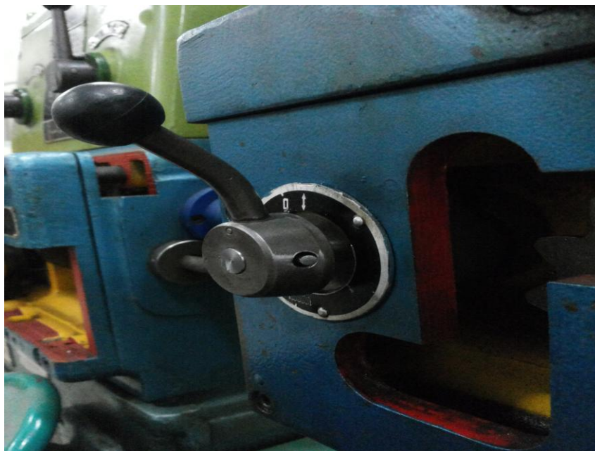
Εικόνα 4.18 Τοποθέτηση μοχλού στον τόρνο επίδειξης
