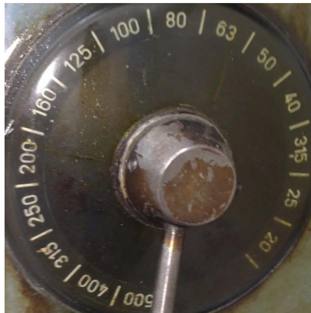
Εικόνα 1.20 Επιλογήας ταχυτήτων προώσεως φρεζομηχανής εταιρείας Strigon, τύπου ME-250 που βρίσκεται στη θέση Νο.4 στο μηχανολογικό εργαστήριο II
