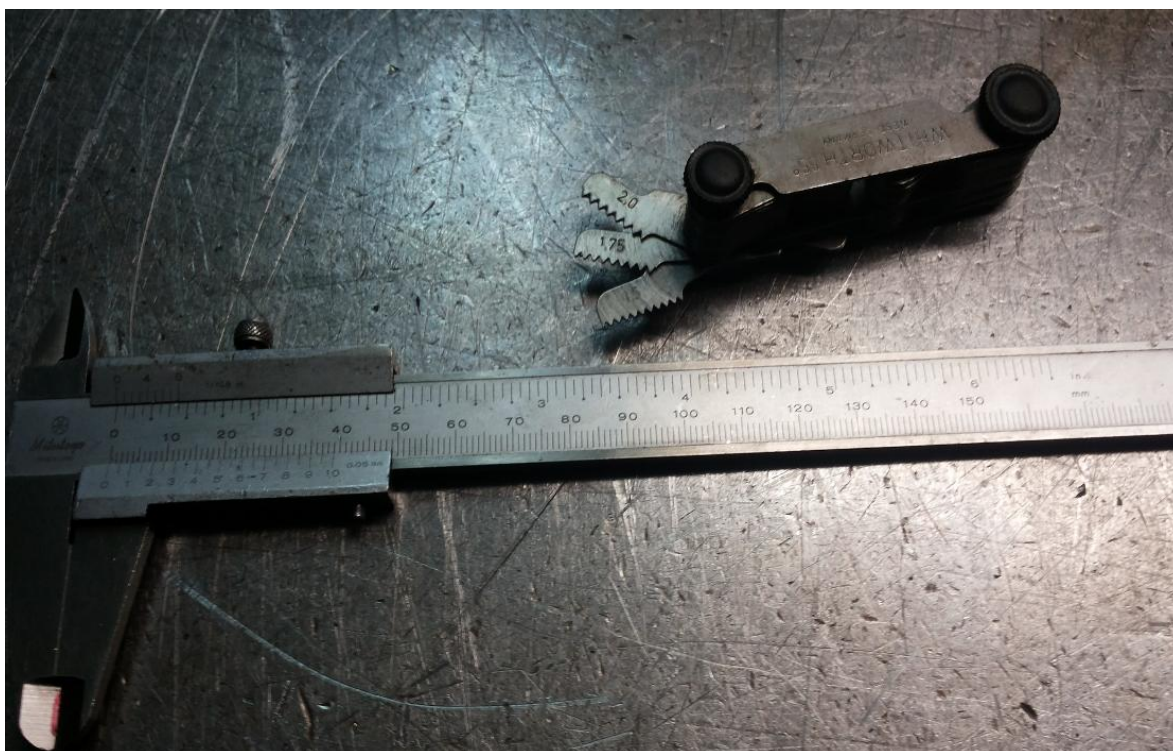
Εικόνα 4.8 Παχύμετρο και σπειρόμετρο.
