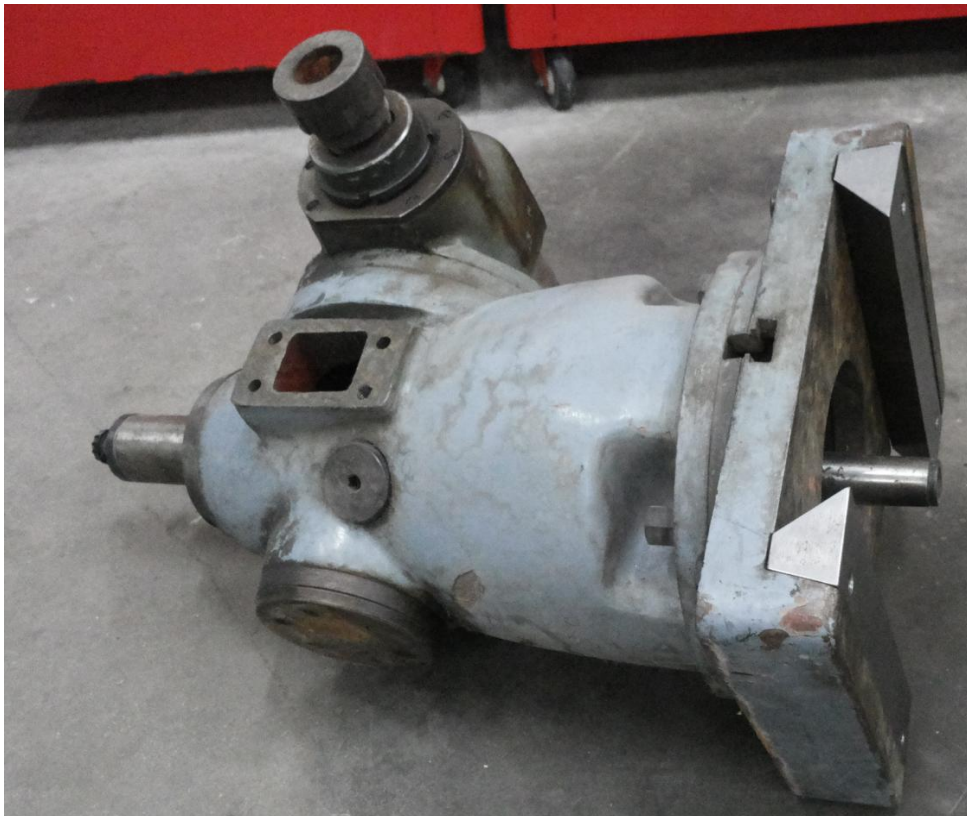
Εικόνα 4.38 Τοποθέτηση πρισματοδηγών στην κάθετη κεφαλή φρεζομηχανής.
