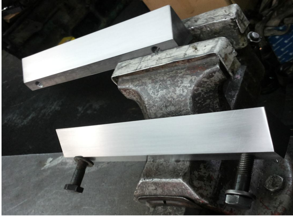
Εικόνα 4.37 Πρισματοδηγοί μετά τη λείανση.
