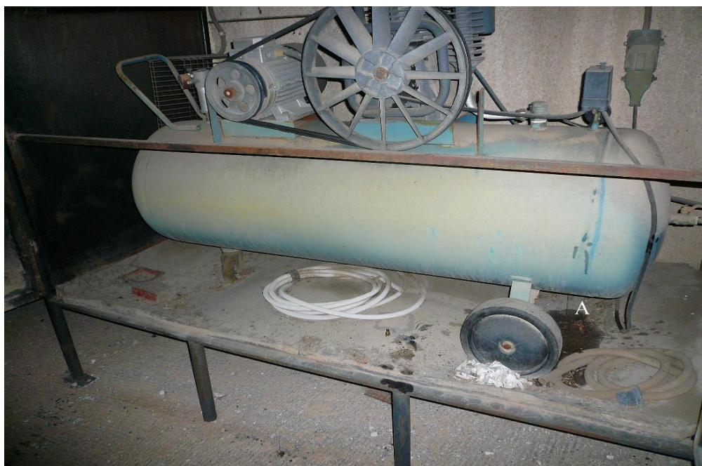
Εικόνα 4.24 Αεροσυμπιεστής εργαστηρίου εργαλειομηχανών.
