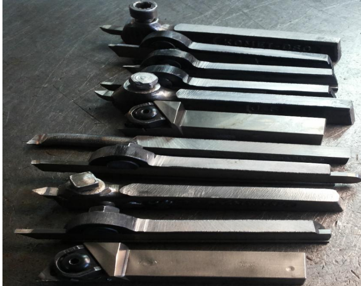
Εικόνα 4.6 Ορισμένες μανέλες τόνων μετά από την επιπέδωση.
