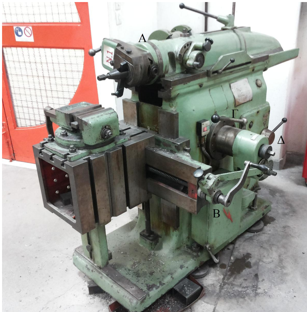
Εικόνα 4.29 Πλάνη για την ολοκλήρωση της κατεργασίας.
