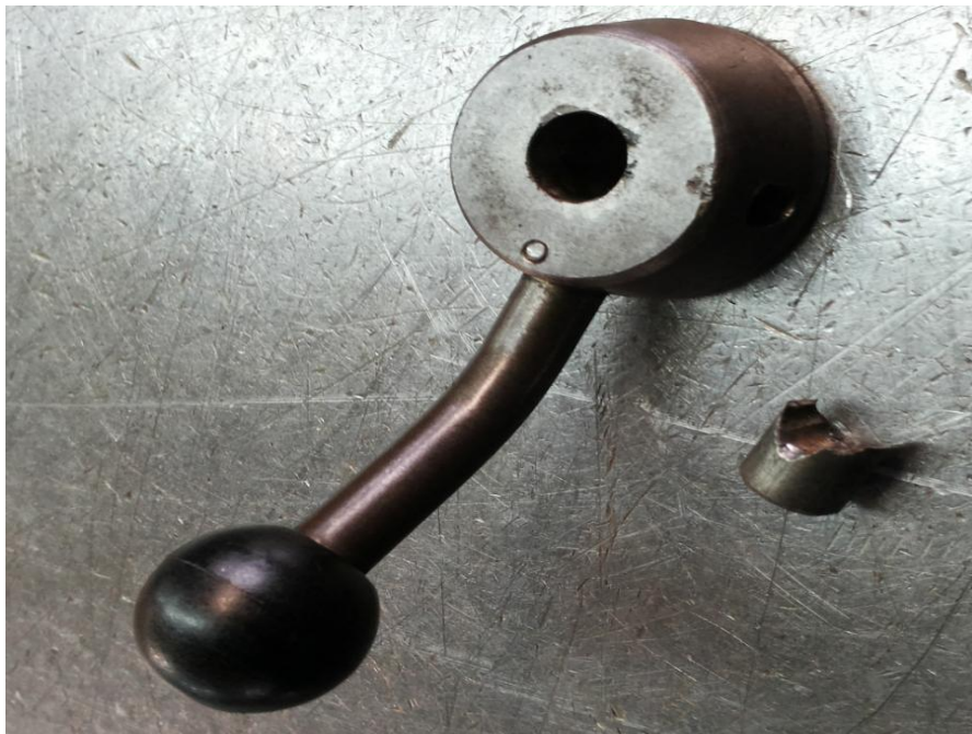
Εικόνα 4.14 Απεικόνιση του υπόλοιπου σπασμένου κομματιού.
