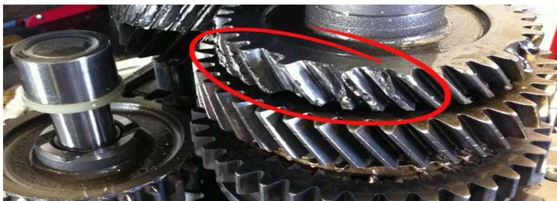
Εικόνα 3.1 Φθορά γραναζιών στο κιβώτιο ταχυτήτων.
