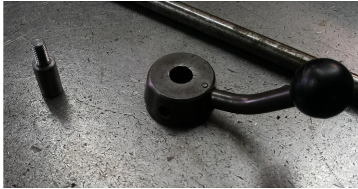
Εικόνα 4.16 Κατεργασμένη προέκταση άξονα στις απαιτούμενες διαστάσεις.
