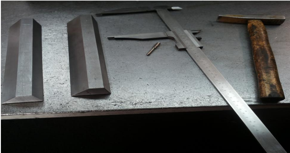
Εικόνα 4.34 Εργαλεία για κεντράρισμα των οπών.
