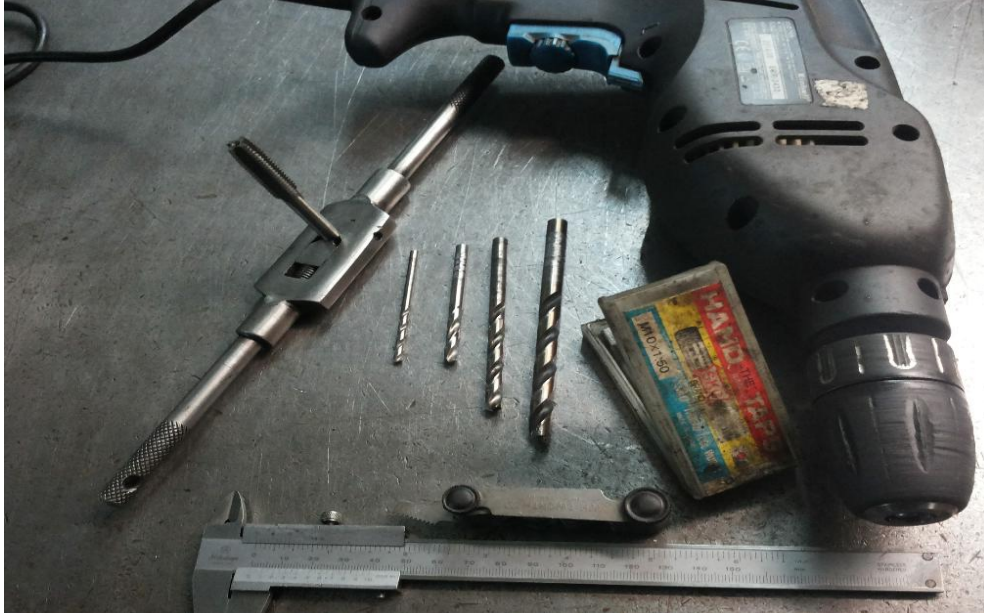
Εικόνα 4.11 Εργαλεία για την διάνοιξη οπής και σπειρώματος.
