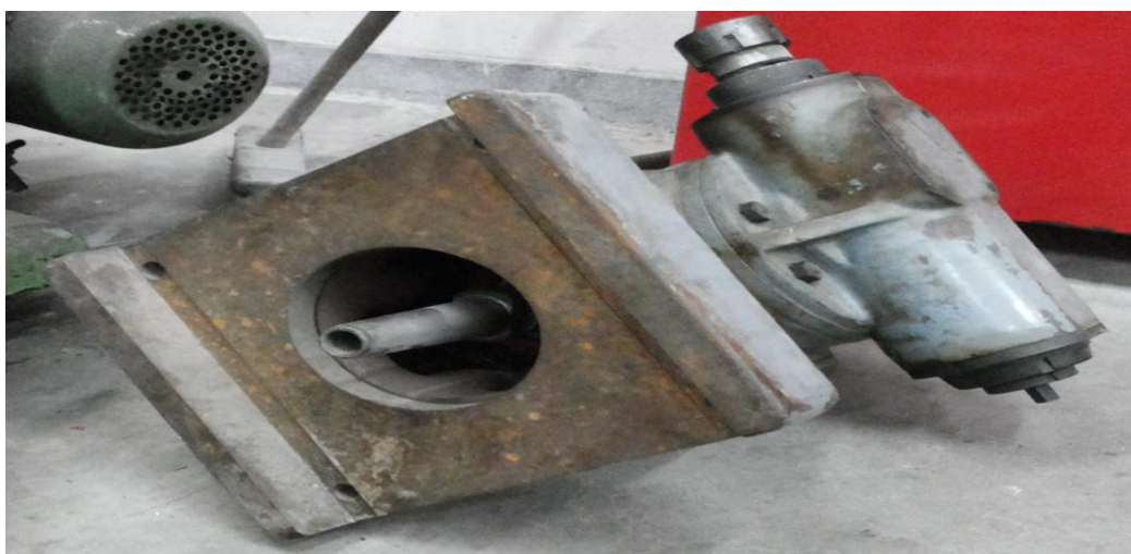
Εικόνα 4.27 Κάθετη κεφαλή φρεζομηχανής.
