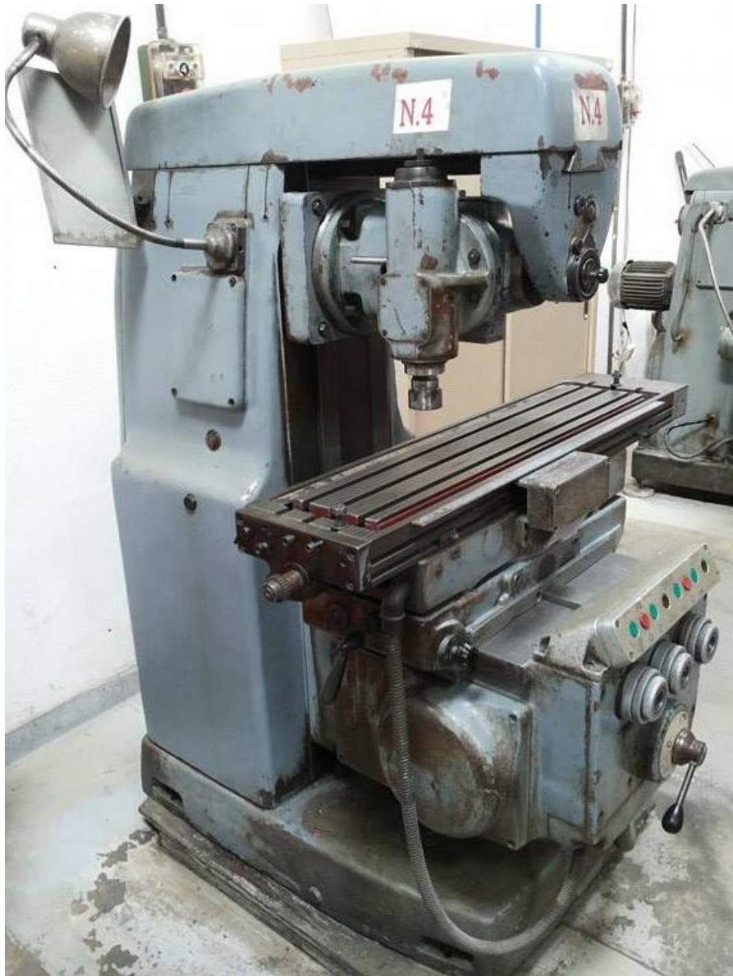
Εικόνα 4.39 Η φρεζομηχανή No.4 με εγκατεστημένη την κάθετη κεφαλή.
