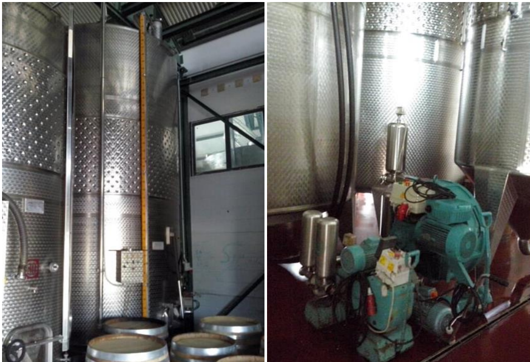
Εικόνα 10 Τα μηχανήματα και ιδίως οι δεξαμενές συνιστάται να είναι κατασκευασμένα από ανοξείδωτο χάλυβα
