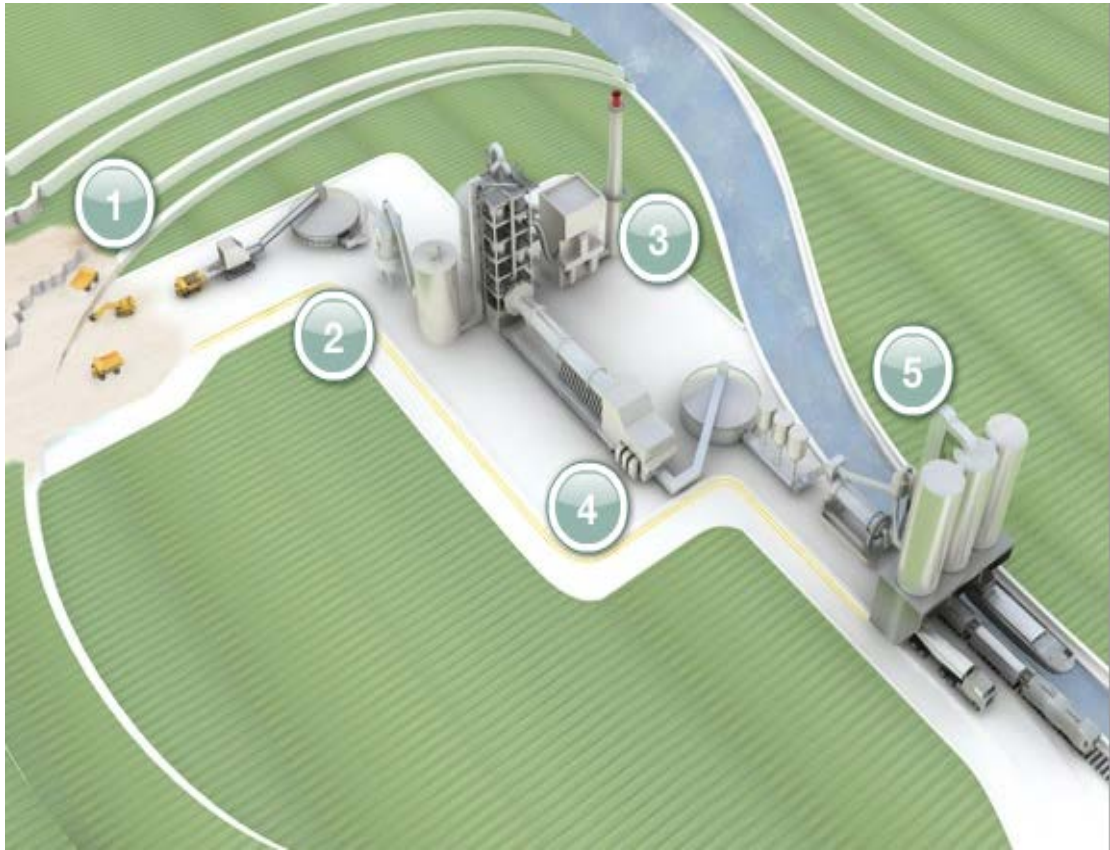
Εικόνα 19 Στάδια παραγωγής τσιμέντου
