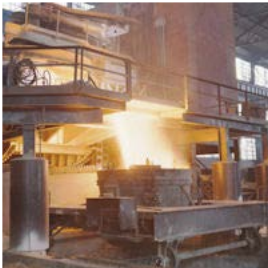
Εικόνα 8 Κλίβανος ηλεκτρικού τόξου
