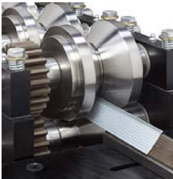
Εικόνα 16 Διαμόρφωση γωνιάς εν ψυχρώ
