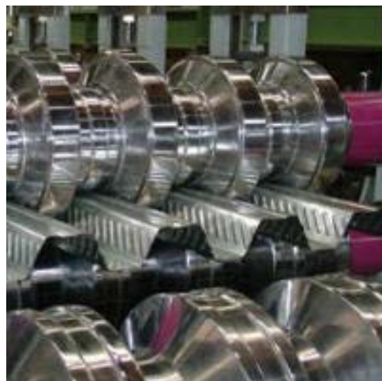
Εικόνα 13 Διαμόρφωση χαλυβδόφυλλων για σύμμικτες πλάκες
