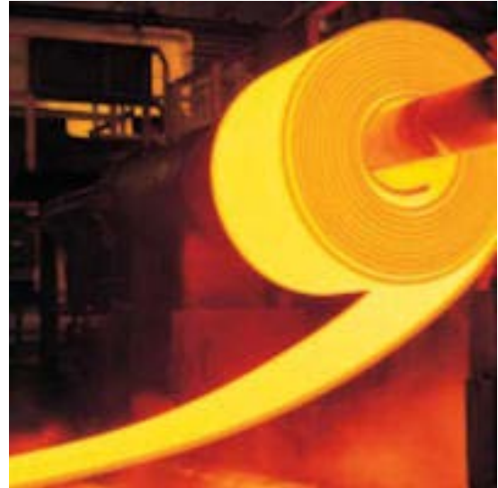
Εικόνα 9 Περιέλιξη Ελάσματος εν Θερμώ
