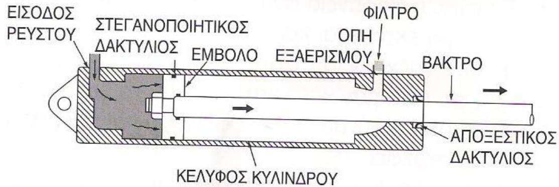
Εικόνα 2 :Δομή εμβόλου απλής ενέργειας
