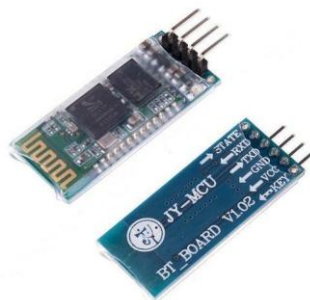
Εικόνα 2.3: Bluetooth Module HC-06
