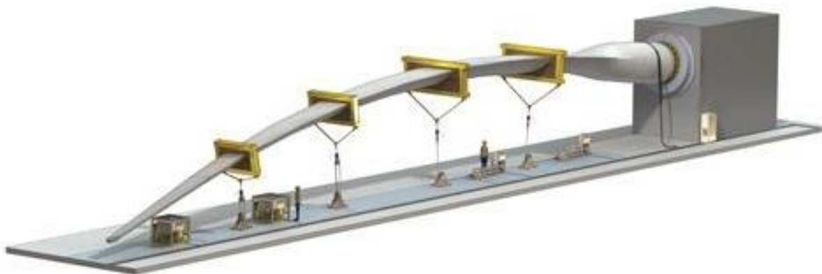
Σχ 2.14. Τεστ αντοχής των υλικών κατασκευής πτερυγίου
