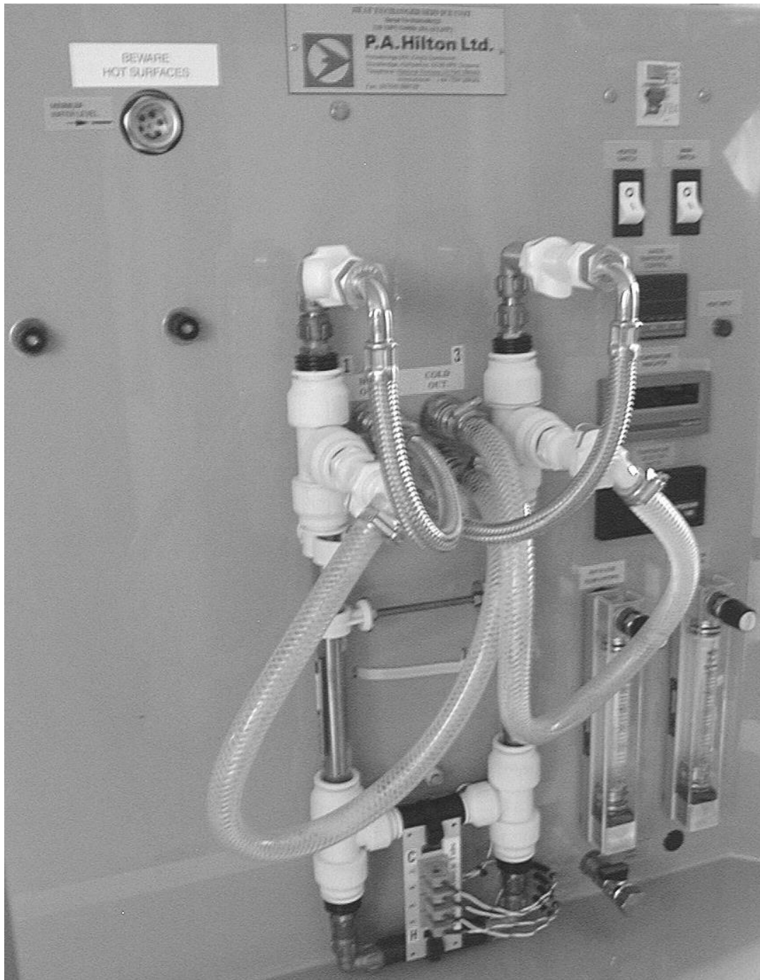
Σχήμα 3.1: H102A Εναλλάκτης ομόκεντρων σωλήνων, τοποθετημένος στη μονάδα H102
