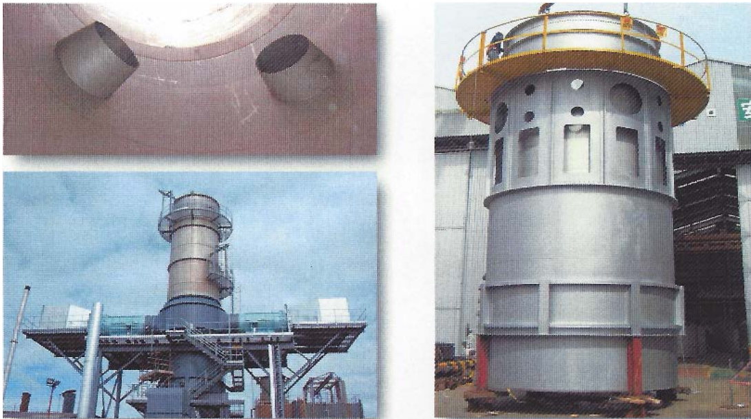
Μονάδα καύσης αερίου πριν την εγκατάσταση στο χώρο μηχανοστασίου
