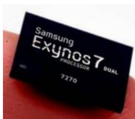
Εικόνα 20: Επεξεργαστής Exynos 7 Dual 7270 της εταιρίας Samsung
