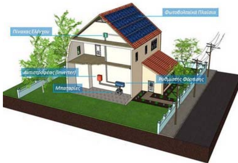
Εικόνα 1.4 Αναπαράσταση αυτόνομου Φ/Β συστήματος με αποθήκευση.
