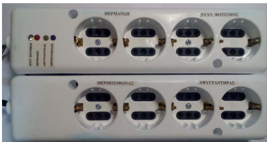
Εικόνα 4.21 Μονάδα διαχείρισης ισχύος ελεγχόμενη από την Κεντρική μονάδα διαχείρισης.
