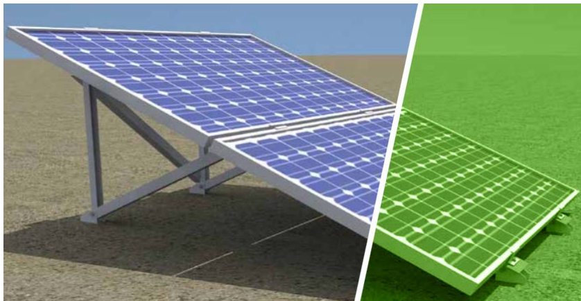
Εικόνα 3.8 Βάσεις στήριξης για 2 Φωτοβολταϊκά πάνελ σε διάταξη Landscape.
