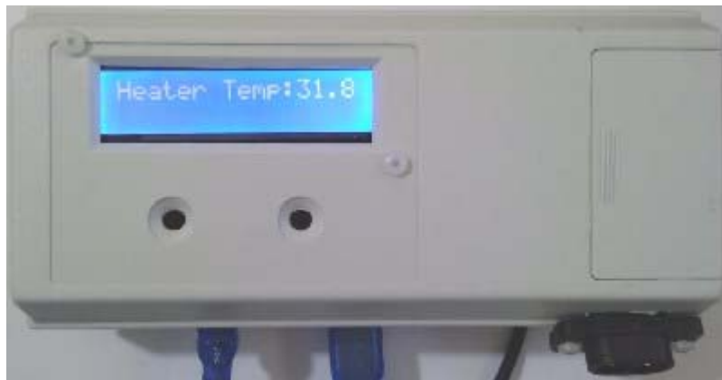
Εικόνα 4.11 Ασύρματο σύστημα ανάγνωσης θερμοκρασίας Θερμοσίφωνα.
