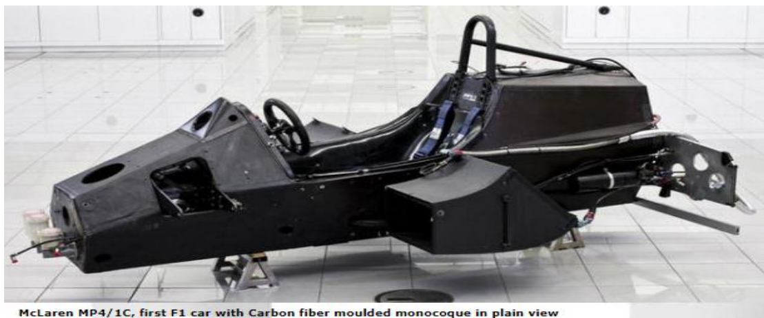
Εικόνα 1-11:Πρώτο αυτοφερούμενο μονοθέσιο από ανθρακονήματα στον θεσμό της Formula 1, από την McLaren( www.formula1-dictionary.net ).
