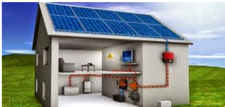
Εικόνα 2.1 Αυτόνομο Φωτοβολταϊκό Σύστημα
