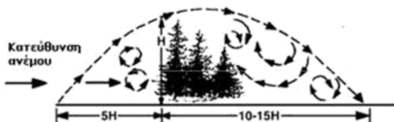
Σχήμα 3.1 Χώρος ισχυρών αναταράξεων γύρω από την περιοχή μεμονωμένου εμποδίου
