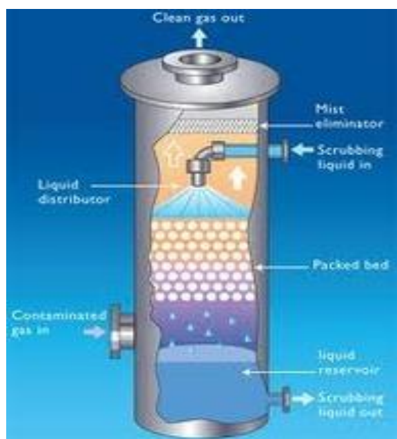
Σχήμα 28. Πλυντρίδα με πληρωτικό υλικό
