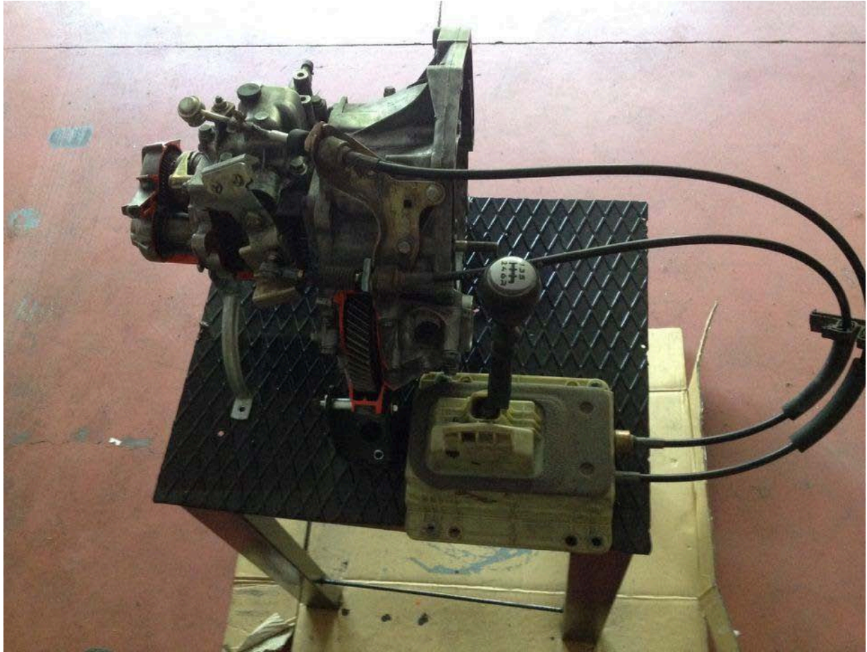
Ολοκληρωμένη βάση στήριξης μηχανικού κιβωτίου σε τομή.
