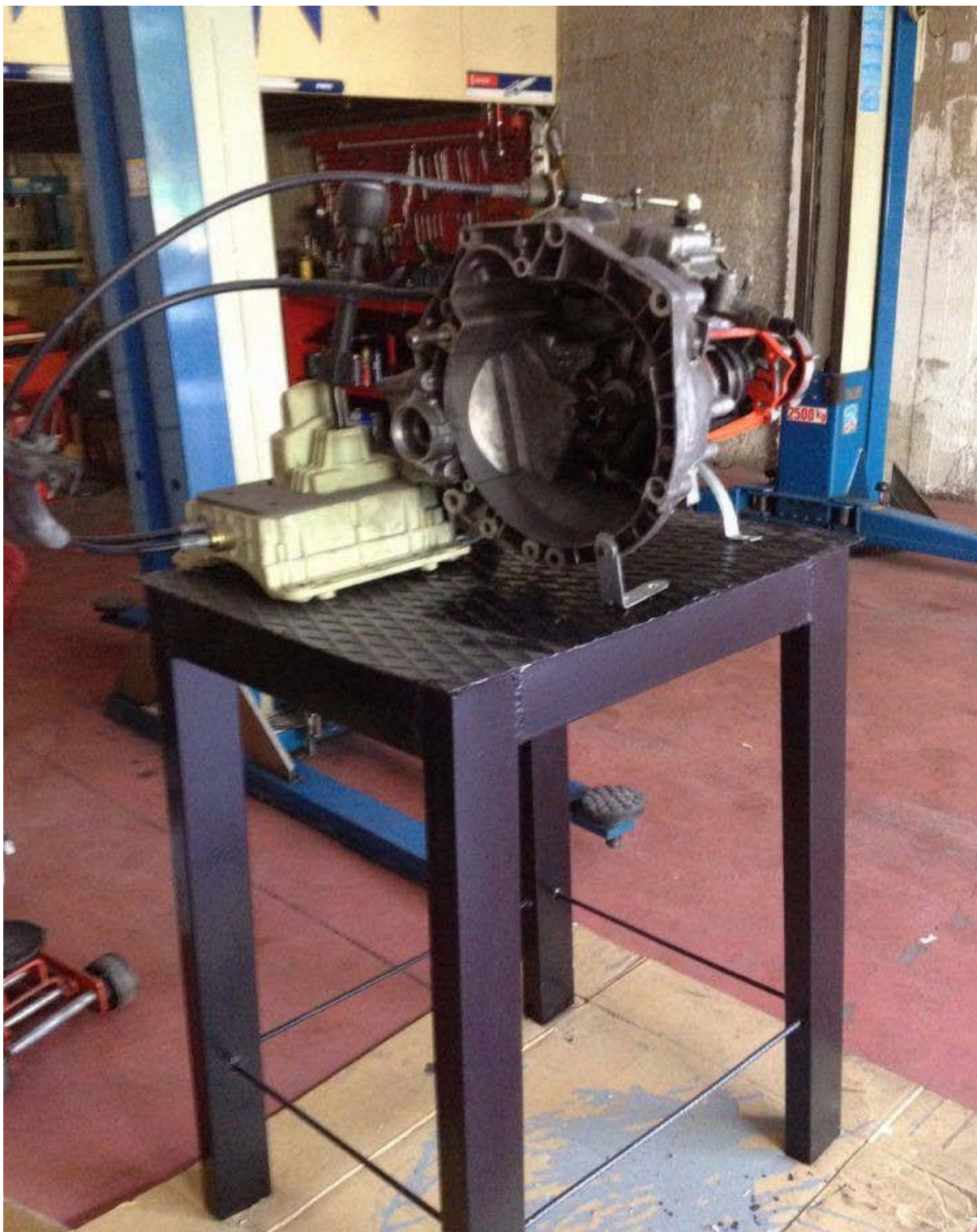
Ολοκληρωμένη βάση στήριξης μηχανικού κιβωτίου σε τομή.
