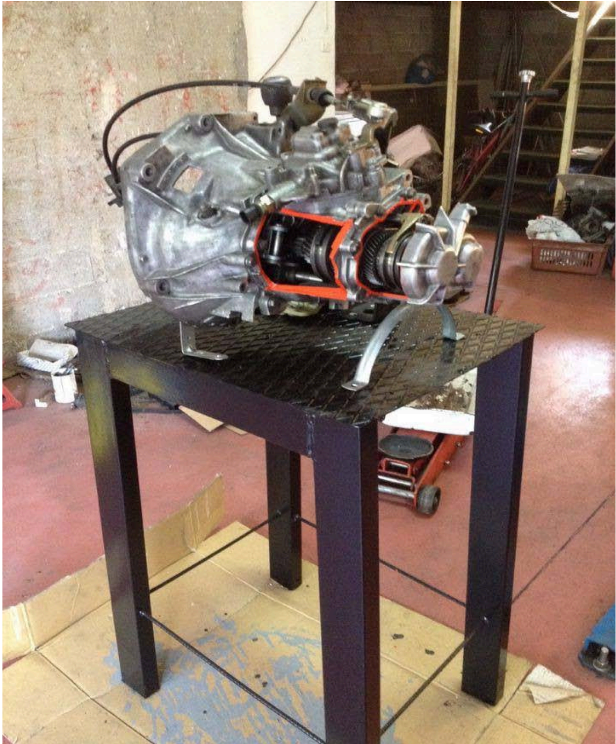
Ολοκληρωμένη βάση στήριξης μηχανικού κιβωτίου σε τομή.
